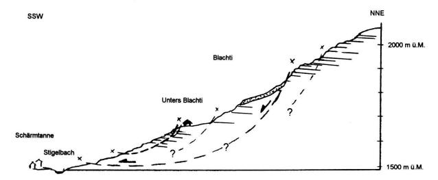
Fig. 2: Vereinfachtes geologisches Profil mit mutmasslichen Gleithorizonten.
