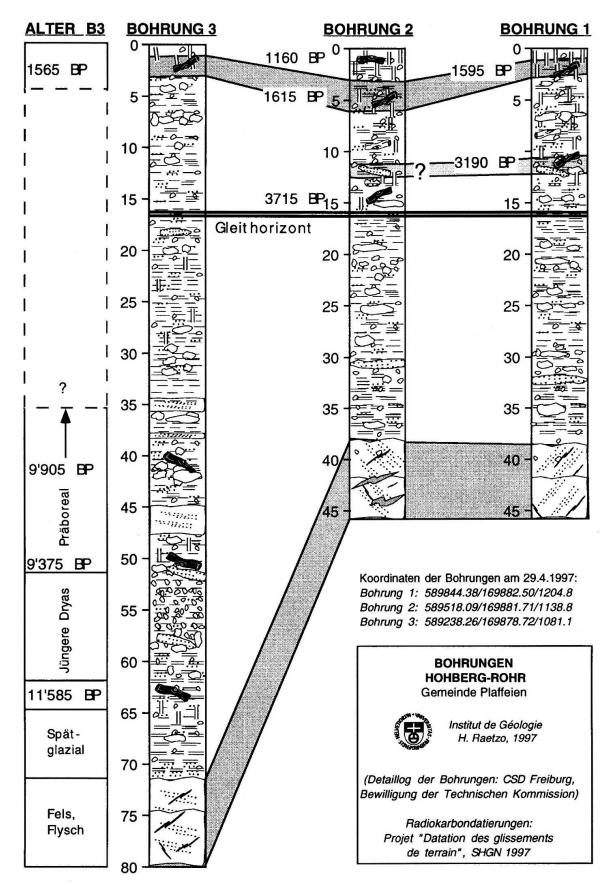
**Fig. 3:** Bohrlogs von F1-3, Lage der Bohrungen siehe Fig. 2. Die Lockergesteine sind mehrheitlich matrixgestützt. Die tonig-siltige Matrix von bindigem Charakter beinhaltet Lagen von Kies, Steinen, Blöcken und selten Sand. Alle Rutsch- und Murgangablagerungen wurden nach der letzten Eiszeit abgelagert.
