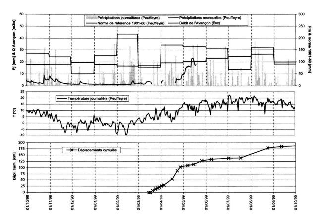
Fig. 2: Diagramme des corrélations climatologique et des déplacements.
