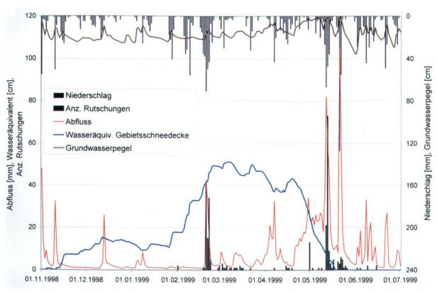
**Fig. 6:** Abfluss, Niederschlag, Wasseräquivalent der Schneedecke, Grundwasserspiegel im Alptal (SZ) und zeitliche Verteilung der Hanginstabilitäten des Jahres 1999.
