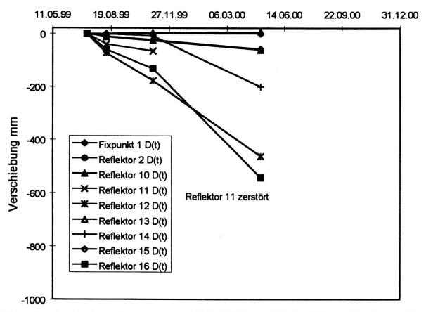
Fig. 3: Resultate der Laser-Distanzmessungen 1999 – 2000 der im Frühjahr 1999 versetzten Messpunkte.
