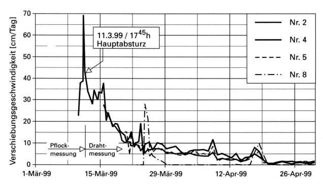
**Fig. 4:** Verschiebungsgeschwindigkeiten ausgewählter Punkte in der Rutschmasse "Bätschen", Messung Nr. 4 bis zum 15.3.99 zwischen 2 Pflöcken, danach Drahtmessungen.
