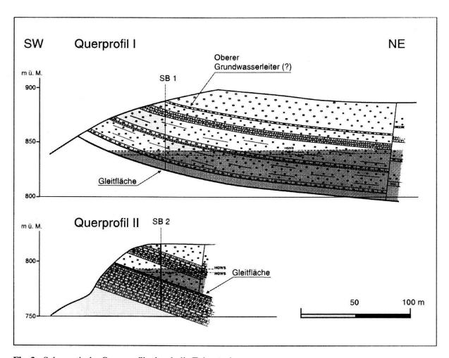
Fig. 3: Schematische Querprofile durch die Felsrutschung.
