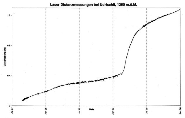
**Fig. 5:** Laser-Messungen bei Udrischli, 1260 m ü.M. Die Distanz zwischen dem ruhigen und dem rutschenden Punkt wird automatisch gemessen. Das Intervall ist programmierbar, es beträgt im Winter eine Stunde, da die Stromversorgung mit Solarzellen nicht mehr Messungen zulässt.
