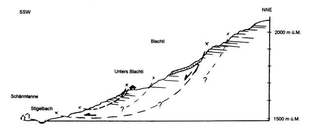
Fig. 2: Vereinfachtes geologisches Profil mit mutmasslichen Gleithorizonten.
