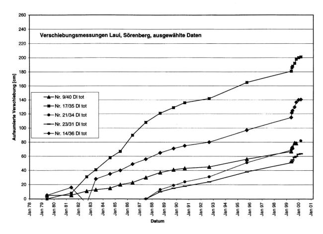
**Fig. 3:** Verschiebungsgeschwindigkeiten ausgewählter Punkte in der Felsrutschungsmasse Laui Sörenberg.
