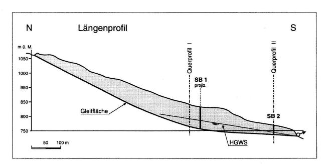
Fig. 2: Schematisches Längenprofil mit Lage des Hangwasserspiegels.
