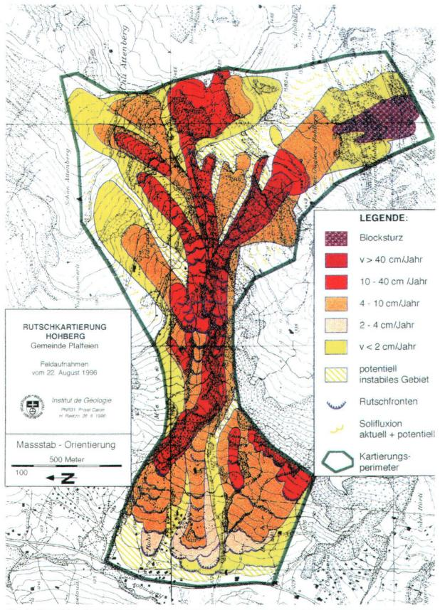
**Fig. 1:** Rutschkartierung Hohberg, Karte der Phänomene vom August 1996. Feldarbeiten im Rahmen des Nationalen Forschungsprogramms 31 (NFP31PNR). Die Rutschung Hohberg-Rohr liegt in der Gemeinde Plaffeien, Kanton Freiburg. Im Tal der Warmen Sense traversiert die Kantonsstrasse Zollhaus-Schwarzsee den Rutschfuss bei Rohr. Die Massenbewegungen haben ihren Ursprung im 1800 m hohen Hohmattli-Hohberg-Massiv.
