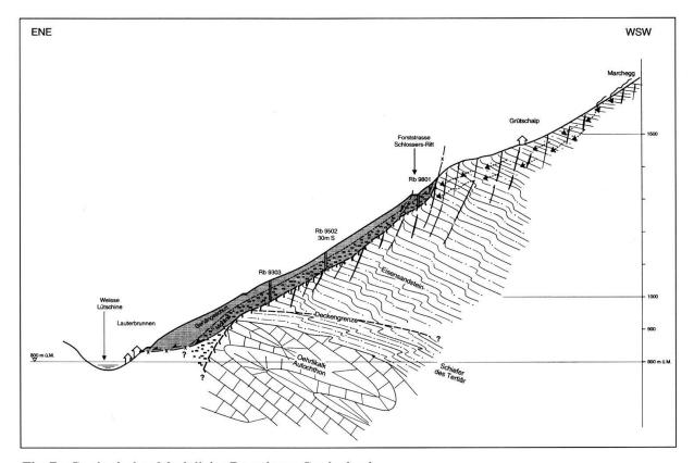
Fig. 7: Geologisches Modell der Rutschung Gryfenbach.
