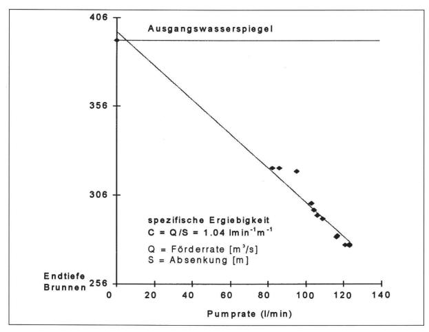
Fig. 5: Leistungscharakteristik des Vertikalfilterbrunnens 98-378B1 im Muschelkalkaquifer.
