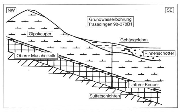
**Fig. 3:** Schematisches überhöhtes geologisches Profil zwischen dem Berg und der DB-Station Trasadingen.
