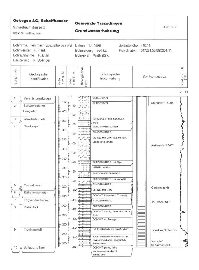
**Fig. 4:** Bohrprofil der Grundwasserbohrung Trasadingen 98-378B1.
