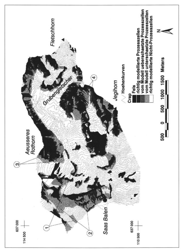
**Fig. 6:** Das Modell "crap" für das Gebiet Saas Balen - Grubengletscher (Zellgrösse 10 m). Dargestellt sind der Fels, die richtig modellierten Ablagerungsflächen, die überschätzten und die unterschätzten Ablagerungsflächen sowie die richtig modellierten steinschlagfreien Gebiete. Die verschiedenen Nummern werden im Text und in Tab. 5 erklärt (Reproduziert mit Bewilligung des Bundesamtes für Landestopographie vom 30. 5. 1998).
