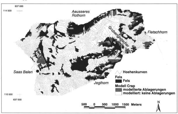
**Fig. 5:** Mit dem Modell "crap" erstellte Gefahrenhinweiskarte für den Prozess Steinschlag im Gebiet Saas Balen - Grubengletscher. Für die vorliegende Karte wurde mit einer Zellgrösse von 25 m gerechnet. Die verschiedenen Kostenfaktoren wurden bei der Modellberechnung berücksichtigt (Reproduziert mit Bewilligung des Bundesamtes für Landestopographie vom 30. 5. 1998).
