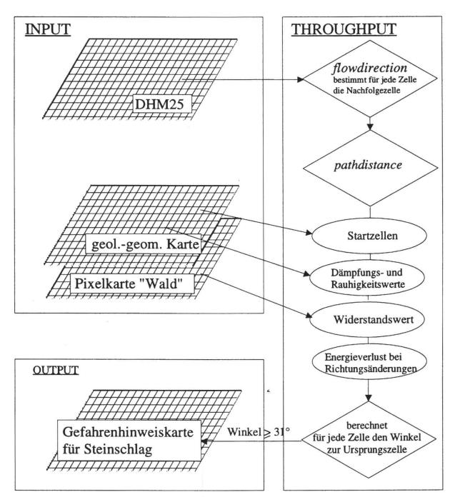
**Fig. 4:** Konzeptioneller Ablauf des Verfahrens "crap". Die Inputdaten sind zumindest teilweise in digitaler Form erhältlich, die Berechnungsschritte werden von dem als AML-Skript geschriebenen Programm automatisch ausgeführt, der Output erfolgt als digitale, georeferenzierte Karte, die für weitere Anwendungen mit GIS verwendet werden kann.
