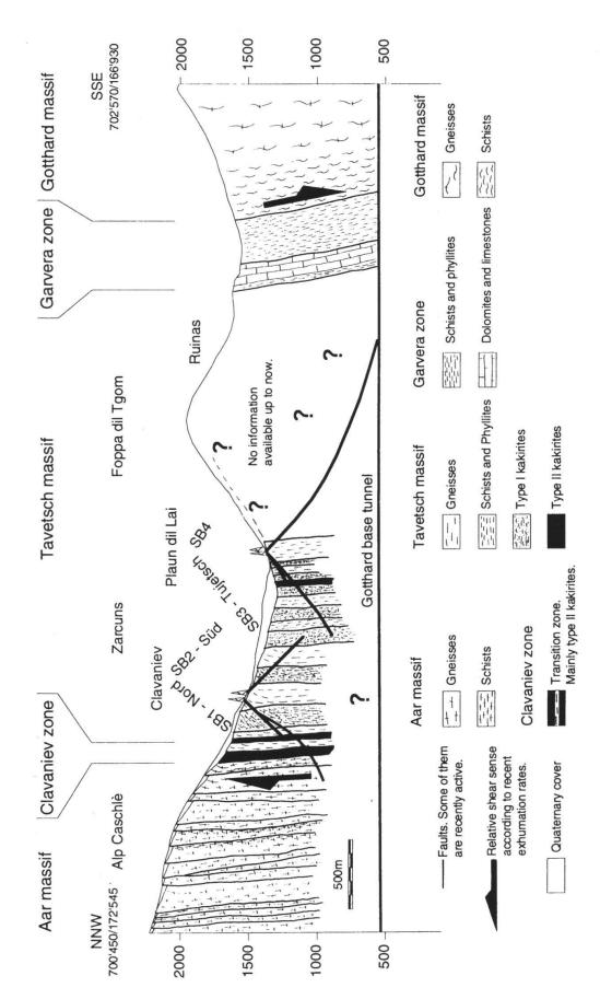
**Fig 3:** Strukturelles Profil entlang des geplanten Gotthard Basistunnels. Zusammengestellt nach Niggli (1944), Eckhardt (1957), Wyss (1986), Schneider (1992, 1994) und eigenen Resultaten.
