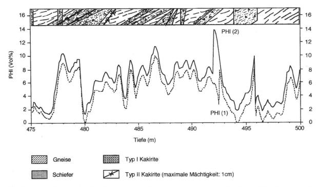
**Fig. 6:** Korrelation der totalen Gesteinsporosität mit dem geologischen Profil aus SB3 - Tujetsch. Die Kurve PHI (1) wurde mit empirischen Schätzwerten der Korndichten und Gesteinsdichtemessungen aus Dichte - Logs konstruiert. Die Kurve PHI (2) beinhaltet Porositätswerte, welche aus pyknometrischen Korndichtemessungen sowie den Dichte - Log Daten berechnet wurden. Die punktuell gemessenen Korndichten wurden als Schätzwerte über das geologische Profil verteilt (Wyder & Rybach 1996).
