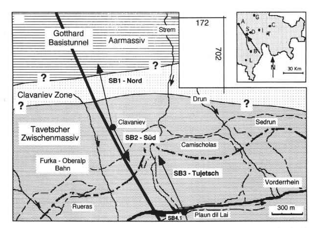
**Fig. 2:** Arbeitsgebiet mit den Spuren der Sondierbohrungen SB1 - Nord, SB2 - Süd, SB3 - Tujetsch und SB4.1. Die Koordinaten in Figuren 1 und 2 entsprechen den Koordinaten der Schweizerischen Landeskarte. A = Altdorf, B = Biasca, C = Chur, D = Disentis, G = Glarus, I = Ilanz, L = Locarno, S = Sedrun, T = Thusis.
