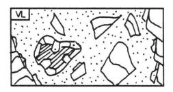
e) VL, Phase VI: Bildung von Verwerfungsletten durch anhaltendes Brechen und Abrasion von Gefügedomänen. Ausfällung von Smectit und Opakmineralien. Permeabilitätsschwund.
