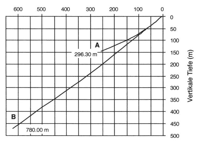
Fig. 4: Neigungsverlauf von SB3 - Tujetsch (mittleres Azimut = 338°).
