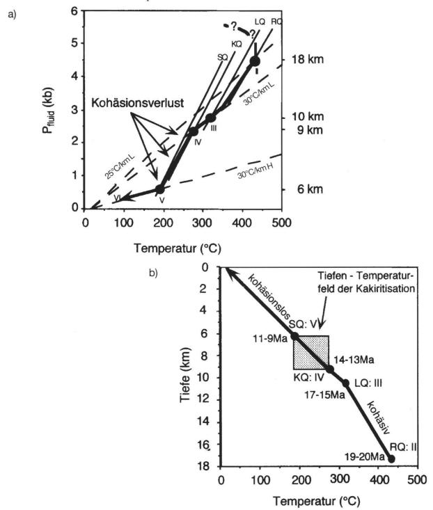
**Fig 8:** Kompilierter P-T Pfad der Kakiritisierung mit Tiefenkorrelation (a) und entsprechender Tiefen-Temperatur Pfad mit Alterskorrelation (b) aus Wyder und Mullis (1998, im Druck). L = lithostatisch, H = hydrostatisch; weitere Abkürzungen siehe Text.
