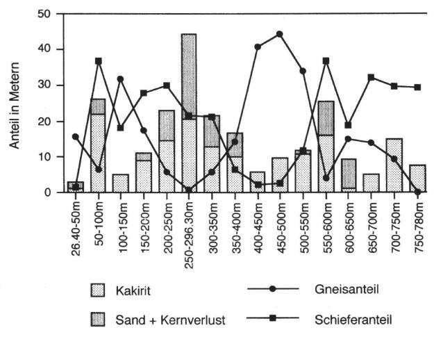
**Fig. 5:** Vergleich Kakirithäufigkeit - Gneis- bzw. Schieferanteil in 50m Intervallen; Bohrung SB3 - Tujetsch. Eine auffällige Tendenz in der Bohrung SB3 - Tujetsch ist die zunehmende Häufigkeit von Kakiriten bei zunehmendem Schieferanteil im Gestein.
