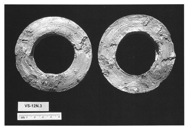
Fig. 6: Aufgebrochener Probenkörper mit Rutschharnischflächen.
