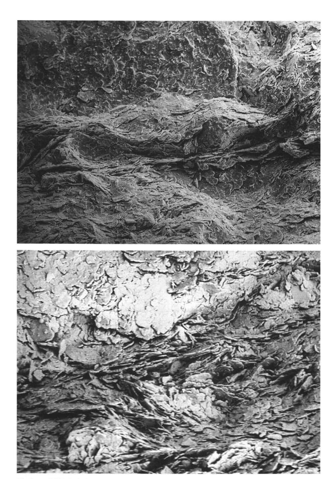
Fig. 8: REM-Aufnahmen der Scherfugen der Probekörpers VS-3 (oben) und Hohberg (unten).
