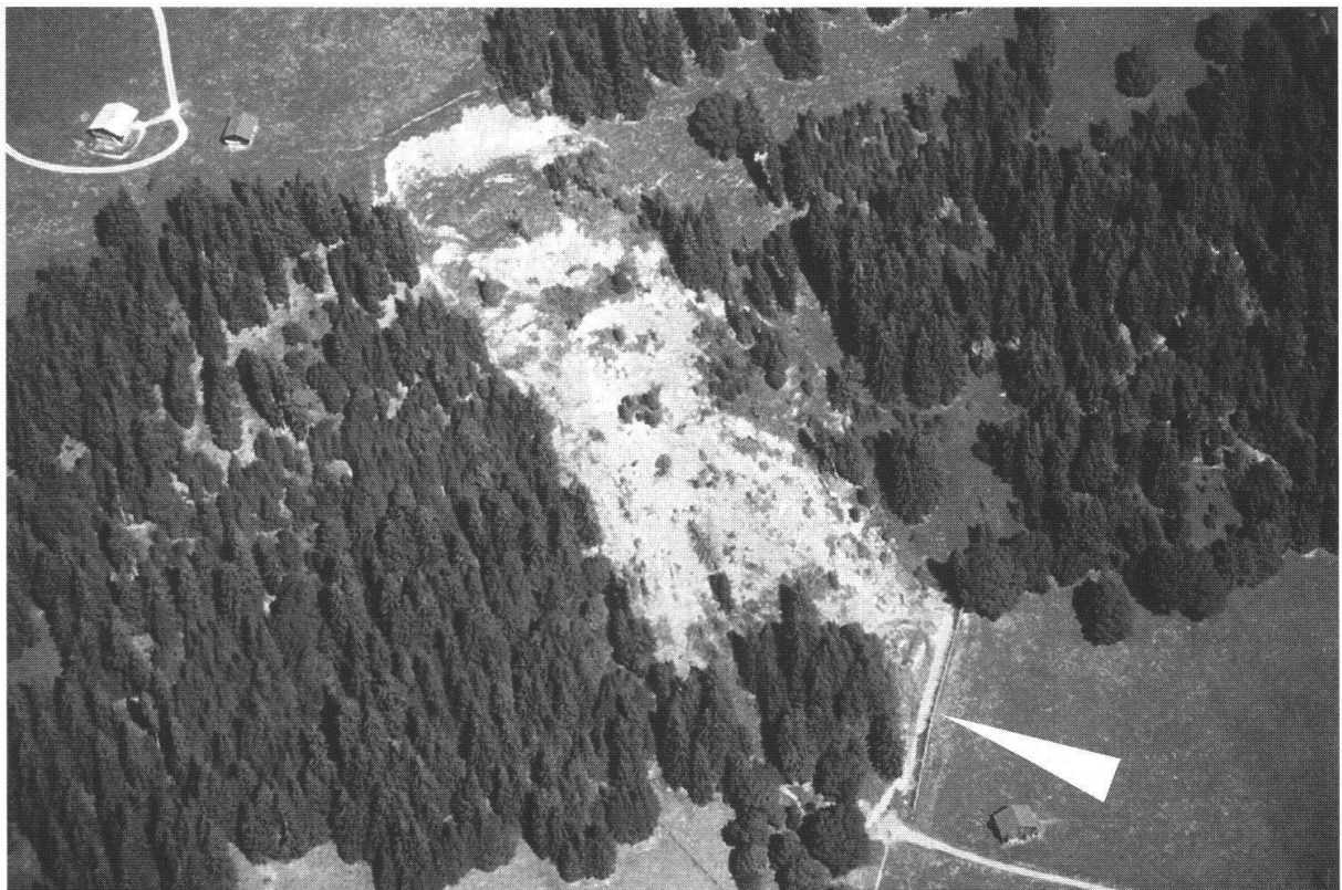
Fig. 1: Flugaufnahme der Rutschung/Sackung aus dem Sommer 1993. Unten rechts ist ein Teil des erstellten Auffangdammes sichtbar (Pfeil). Foto: G. della Valle
