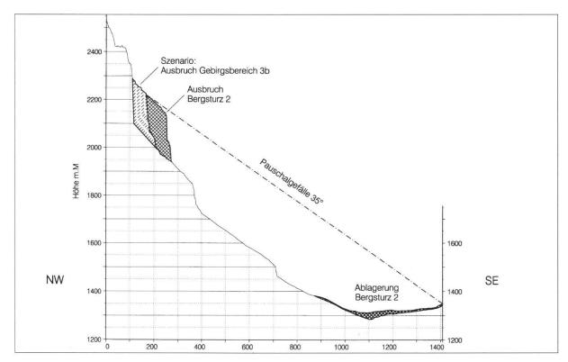
Fig. 6: Querprofil durch Ausbruch und Ablagerung von Bergsturz 2.
