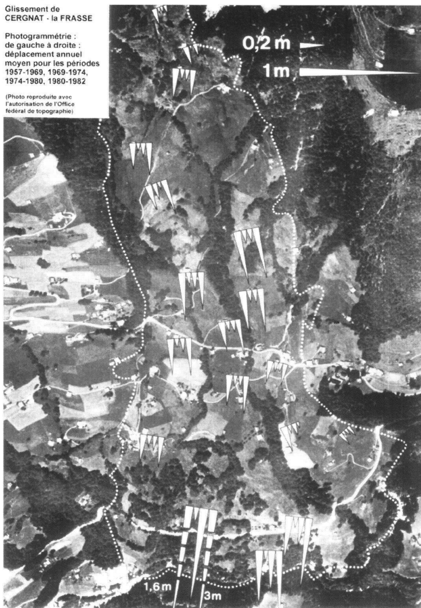
Fig. 2: Restitution photogram- métrique des déplace- ments pour diverses pé- riodes (Source: Institut de Photogrammétrie de l'EPFL)
