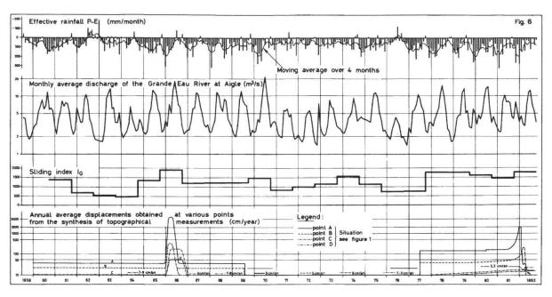
**Fig. 6:** Evolution comparée des mouvements, de la pluviométrie efficace, des débits de la Grande Eau, et d'un «indice de glissement» intégrant les données climatologiques, les données hydrologiques (lame d'eau écoulée sur le glissement, périodes de restitution excédentaires et déficitaires des eaux souterraines), les données limnigraphiques.
