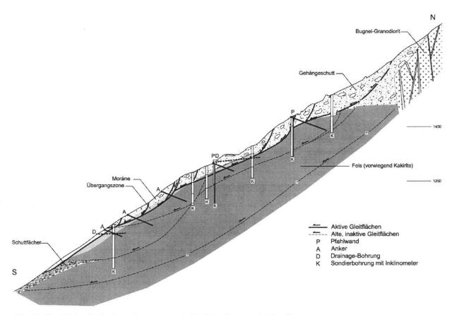
Fig. 5: Profil durch die Rutschzone Arschella (Profilspur vgl. Fig. 3).
