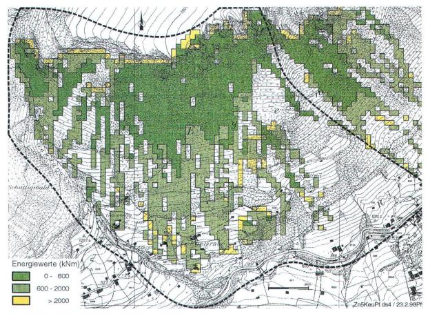
Fig. 3: Berechnete Sturzenergien für Blöcke 4 m<sup>3</sup>
