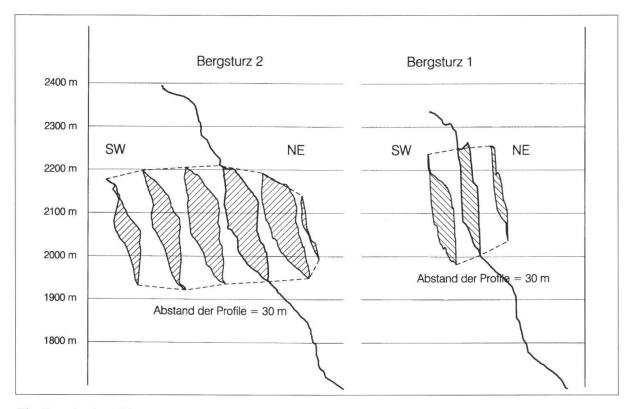
**Fig. 5:** Ausbruchkörper der Stürze 1 und 2.
