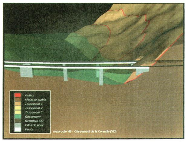
**Fig. 2:** infographie géologique tridimensionnelle du glissement de la Cornalle dans la zone du franchissement par l'autoroute N9 (tiré de Mayoraz 1993).
