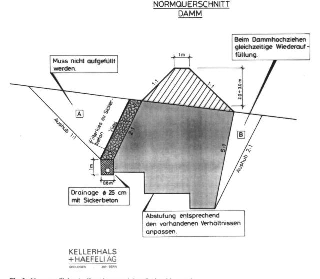
Fig. 2: Normprofil des Auffangdammes (ohne Steinschlagnetz)
