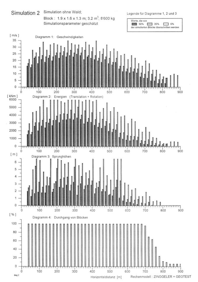
Fig. 7: 2-D-Simulation, Analyse von Geschwindigkeiten, Energien, Sprunghöhen und Frequenzen.
