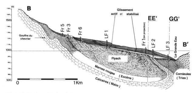
Fig. 4: Profil en long géologique du glissement
