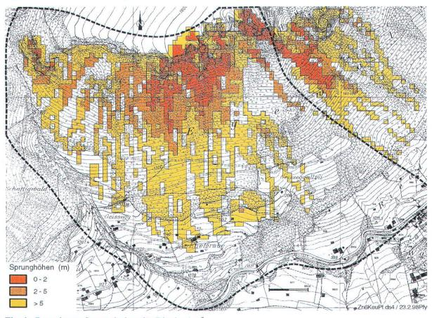
**Fig. 4:** Berechnete Sprunghöhen für Blöcke 4 m<sup>3</sup>
