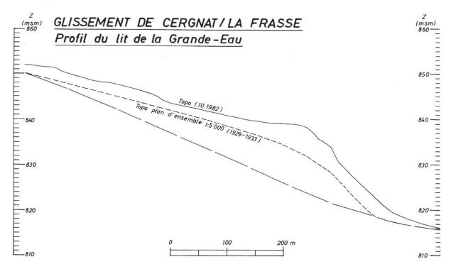
Fig. 7: Evolution comparée du profil en long de la Grande Eau
