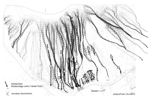
**Fig. 2:** Ereignisdokumentation (frühere Blockschläge) und mit dem Modell Zinggeler-Geotest berechnete Sturzbahnen von Blockschlägen und frühere Ereignisse.
