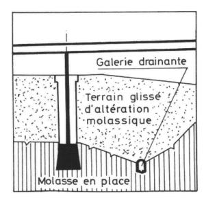
**Fig. 4:** piles chemisées dans les puits de fondation du pont; l'espace E permet un éventuel déplacement du glissement sans mettre en péril gravement l'ouvrage (d'après documentation du Bureau des autoroutes du canton de Vaud).
