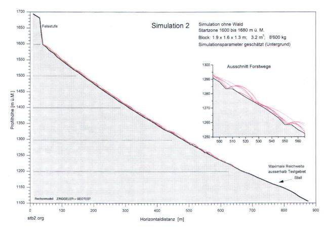
Fig. 6: 2-D-Simulation im Profil
