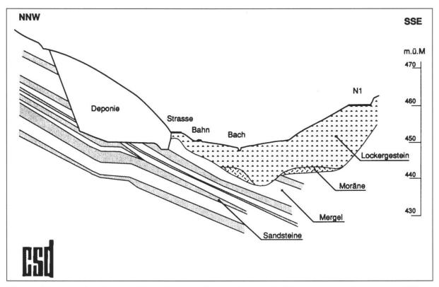
Fig. 3: Schematisches Querprofil durch die Sondermülldeponie Kölliken, stark überhöht, Stand 1995
