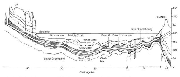
Fig. 10: Geologisches Längsprofil des Ärmelkanaltunnels (aus Margon 1996).
