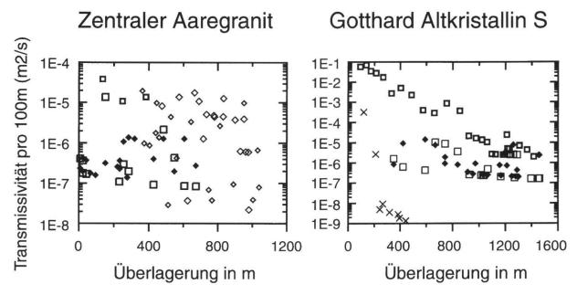
**Fig. 7:** Korrelationsdiagramme der Gebirgsüberlagerung mit den Transmissivitäten 100 m langer Tunnelabschnitte im zentralen Aaregranit (links) und dem südlichen Altkristallin des Gotthard-"Massivs" (rechts). Die verschiedenen Symbole kennzeichnen unterschiedliche Tunnels.
