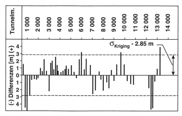
Fig. 12: Differenz tatsächliche Tiefenlage minus Prognose der Basis der Kreidekalke im französischen Abschnitt des Ärmelkanaltunnels (nach Blanchin and Chilès 1992).
