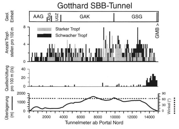
**Fig. 6:** Hydrogeologische Grundlagendaten des Gotthard-SBB-Tunnels (AAG: Zentraler Aaregranit, ASG: südliches Altkristallin Aarmassiv, UGZ: Urseren-Garvera-Zone, GAK: nördliches Altkristallin Gotthard-"Massiv", GSG: südliches Altkristallin Gotthard-"Massiv", GMB: südliche Sedimentbedeckung Gotthard-"Massiv").
