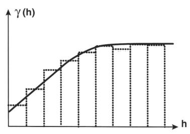
Fig. 8: Experimentelles Variogramm (oben) und Variogramm-Modell (unten).
