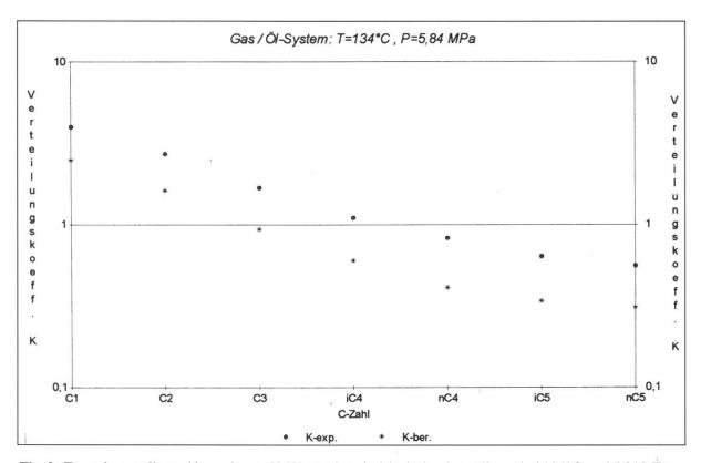
Fig. 3: Experimentelle und berechnete K-Werte der niedrigsiedenden Alkane bei 134°C und 5,84 MPa
