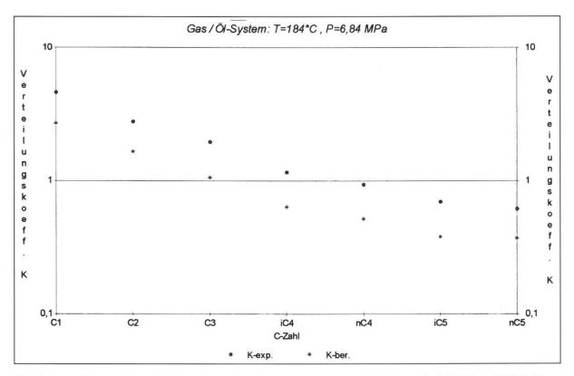
Fig. 4: Experimentelle und berechnete K-Werte der niedrigsiedenden Alkane bei 184°C und 6,84 MPa
