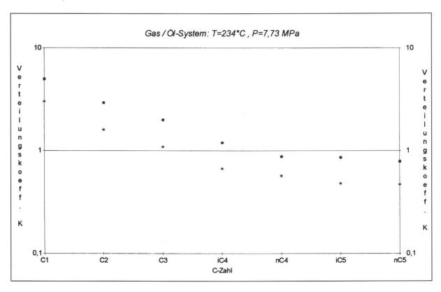
Fig. 5: Experimentelle und berechnete K-Werte der niedrigsiedenden Alkane bei 234°C und 7,73 MPa
