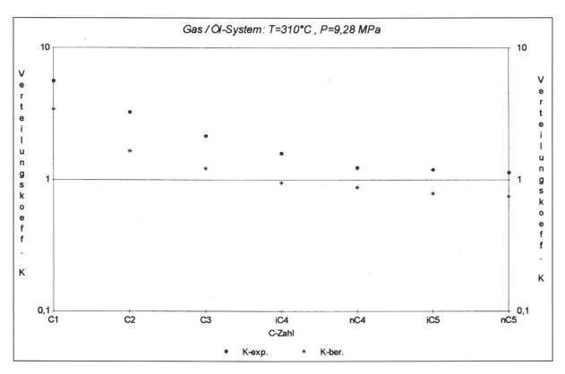
Fig. 8: Experimentelle und berechnete K-Werte der niedrigsiedenden Alkane bei 310°C und 9,28 MPa
