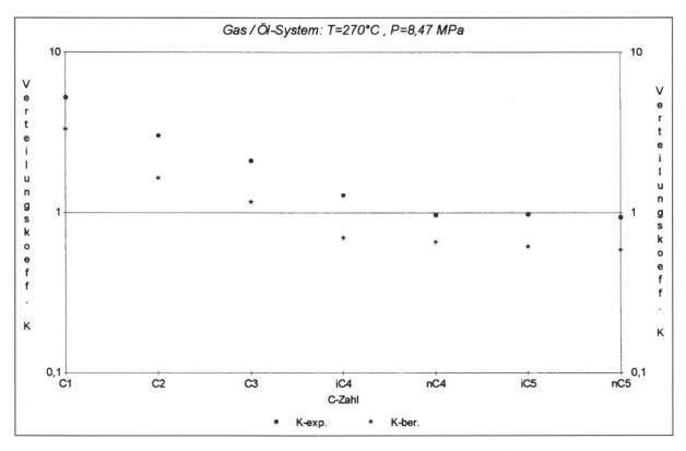
Fig. 6: Experimentelle und berechnete K-Werte der niedrigsiedenden Alkane bei 270°C und 8,47 MPa
