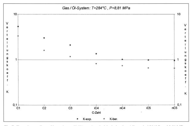
Fig. 7: Experimentelle und berechnete K-Werte der niedrigsiedenden Alkane bei 284°C und 8,81 MPa
