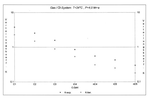
Fig. 2: Experimentelle und berechnete K-Werte der niedrigsiedenden Alkane bei 34°C und 4,0 MPa
