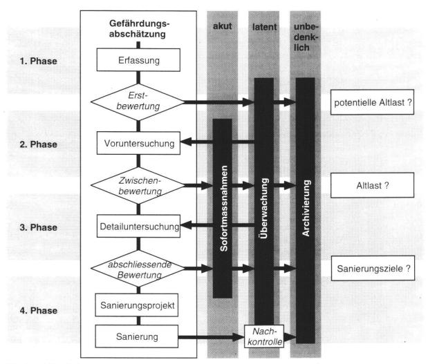
Fig. 1: Ablaufschema des BUWAL für die Altlastenbearbeitung (BUWAL 1994)
