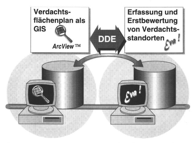
**Fig. 6:** Verknüpfung der beiden Applikationen über eine Schnittstelle für dynamischen Datenaustausch.
