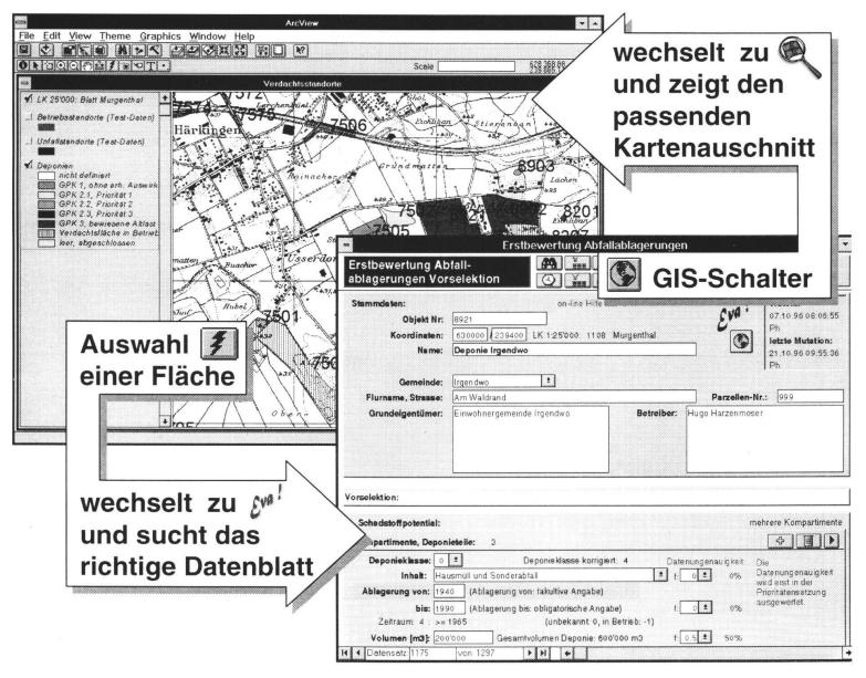
Fig. 7: Wechsel zwischen Verdachtsflächenplan und Datenbank der belasteten Standorte und umgekehrt.
