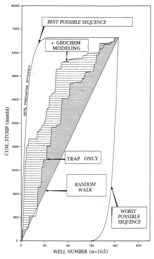
**Figur 4:** Vergleich der Voraussagen basierend (1) allein auf Grösse der Strukturen und (2) mit Anwendung eines Petroleum System Modells. Die letztere Kurve liegt bedeutend näher der Ideallinie.
