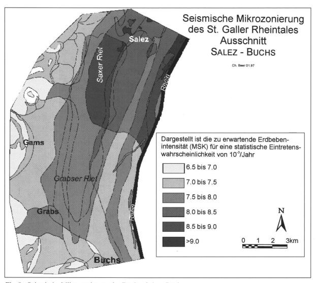
Fig. 8: Seismische Mikrozonierung der Region Salez - Buchs
