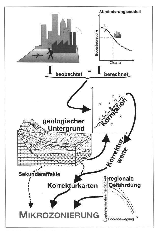
Fig. 4: Schema der seismischen Mikrozonierung
