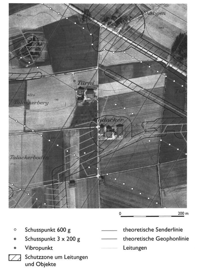
**Fig. 4:** Beispiel für das angepasste Messnetz. Die Grösse der Schutzzonen richtet sich nach der zum Einsatz kommenden seismischen Quelle. (Digitaler Übersichtsplan mit freundlicher Genehmigung des Meliorations- und Vermessungsamts des Kantons Zürich vom 9. Oktober 1996).
