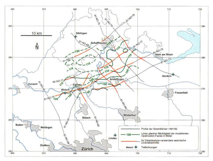
**Fig. 5:** Mächtigkeitskarte der modellierten Opalinuston-Sequenz; für belastbare Ergebnisse bedarf es einer guten Seismikqualität, die zumindest auf den rot markierten Linienabschnitten erreicht wurde. Die grünen Isopachen zeigen, dass die zusammenhängende Ton-Fazies des Aaleniens nach NW generell zunimmt.
