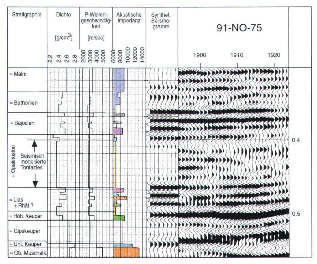
**Fig. 4:** Seismische Modellierung des Abschnitts Keuper - Dogger. Mit Hilfe einer aus den Daten von Weiach abgeleiteten Impedanz-Kurve werden synthetische Seismogramme berechnet und in regelmässigen Abständen in die Oberflächenseismik eingepasst. Dadurch kann - bei Annahme etwa gleichbleibender lithostratigraphischer und petrophysikalischer Verhältnisse - die jeweilige Mächtigkeit des Opalinustons ermittelt werden.
