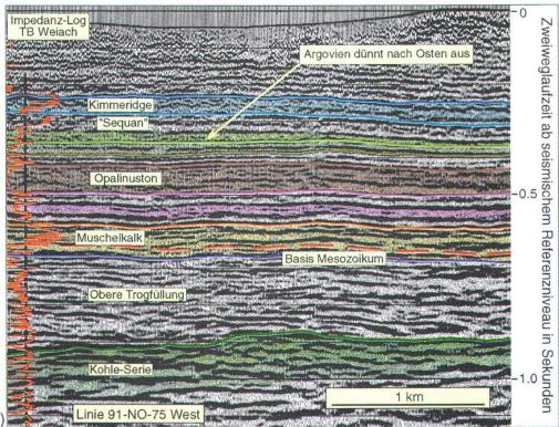
**Fig. 3:** Oben: Ableitung der Markerhorizonte des Mesozoikums aus den Bohrlochdaten der Tiefbohrung Weiach. Das aus den Originaldaten neu berechnete Impedanzlog und das entsprechende Synthetische Seismogramm (ganz links) sind mit der Markerdefinition aus NTB 90-04 (Diebold et al. 1991) ohne Probleme korrelierbar.
