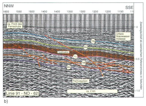
**Fig. 7:** Die seismisch kartierbare Abscherungsfront des Fernschubs im Mesozoikum der Vorfaltenzone nördlich der Lägeren (Profilspuren siehe Fig. 6):
