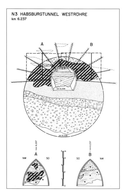
Geologischer Befund im Bereich der Injektionsversuche aus dem Vorstollen der Weströhre. Die Injektionsbereiche der Vorversuche (km 6.237) wurden in quer zur Vortriebsrichtung stehenden Stollen ausgegraben und die injizierten Bereiche (schraffiert) je Injektionsmittel beurteilt (Brustbilder in den Positionen A und B); nach Ausführung der Hauptinjektionen wurden beim nachfolgenden Schildvortrieb die Geologie und das Ausmass der Injektionen im Ausbruchquerschnitt aufgenommen.
