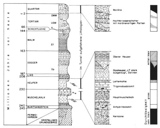
**Fig. 2:** Gliederung des Schichtstosses im Bereich der Habsburgstruktur mit Angabe der im Tunnel aufgefahrenen Abschnitte (OMM: Obere Meeresmolasse, USM: Untere Süsswassermolasse, S: Siderolithikum, Ef: Effinger Schichten, Op: Opalinuston). Der obere Muschelkalk fungiert bei der Therme Bad Schinznach als Thermalwasserleiter; die Evaporite des mittleren Muschelkalks und des Keupers dienten als Abscherungshorizonte bei der Jurafaltung.
