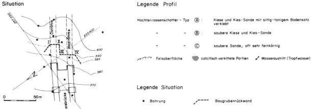
**Fig. 4:** Geologischer Befund im Bereich des Habsburg-Nordportales (Abwicklung der Baugrubenrückwand). Man beachte die tiefgreifende, unruhige Verwitterungszone. Die alten Dolinen, die mit nachgestürztem Material verfüllt sind, wurden in der Baugrubenrückwand randlich angeschnitten.
