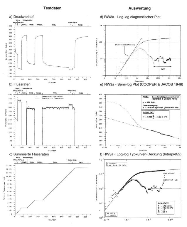
Fig. 3: Testdaten (a-c) und Auswertung (d-m) des Langzeit-Pumpversuchs vom 20.07 - 20.08.1993.
