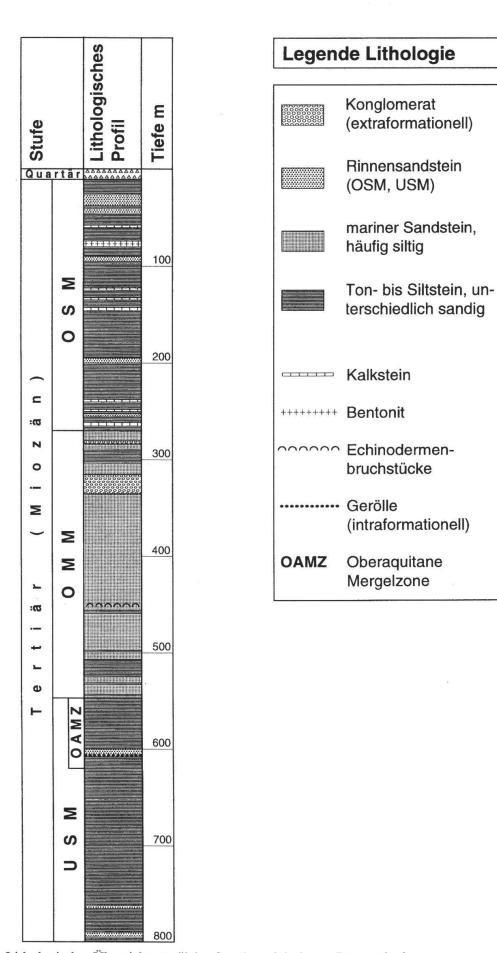
Fig. 1: Lithologisches Übersichtsprofil der Geothermiebohrung Bassersdorf.
