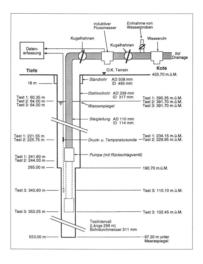
**Fig. 2:** Testanordnung während der Pumptests - Test 1: Kurzzeit-Pumpversuch vom 01.02. - 02.02.93, Test 2: Kurzzeit-Pumpversuch vom 19.03. - 20.03.93, Test 3: Langzeit-Pumpversuch vom 20.07. - 20.08.93
