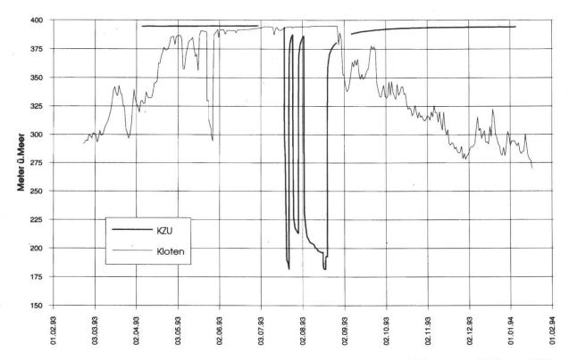
**Fig. 5:** Gemessene Grundwasserspiegelhöhen in den Bohrungen Kloten und Bassersdorf Februar 1993 bis Januar 1994 (Tagesmittelwerte über den gesamten Absenkungsbereich).
