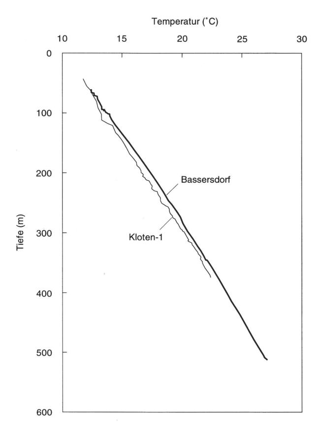
Fig. 6: Gemessener Temperaturverlauf in den Bohrungen Kloten und Bassersdorf.
