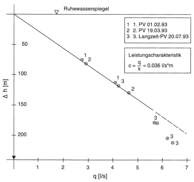
Fig. 4: Brunnencharakteristik Leistungsdiagramm.
