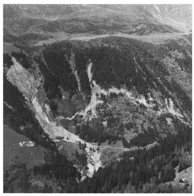
Fig. 2: Panoramique du glissement de Rùtan (versant droit du Val Canaria). L'hameau de Monti occupe une partie des pâturages sur la gauche (en aval par rapport au glissement). La niche d'arrachement apparaît come un ruban blanchâtre irrégulier. En haut à gauche on remarque le grand affleurement rocheux dû a l'éboulement du Riale delle Fontanelle (novembre 1991). Au centre du cliché, vers le bas, on distingue l'important creusement produit par le Rì di Monti pendant l'alluvion de 1993.
