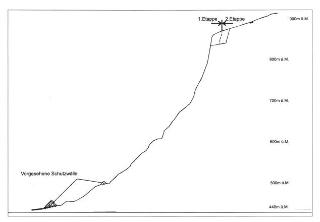
**Fig. 6:** Nicht überhöhtes Profil in der Fallinie der Sturzmassen, mit den Auffangdämmen, Bortwald bei Mollis. Plan Ingenieurunternehmung Bern, 1990.
