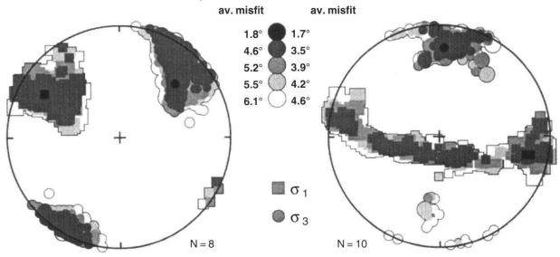
Fig. 12: Dihedra Plots für das Nord- und Südwallis. B: Resultate der Stressinversion.
