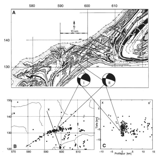
**Fig. 10:** A: Horizontalschnitt in 2500 m ü. M. durch die helvetischen Decken in den Schweizer Westalpen (Burkhard, 1988). B: Epizenterkarte mit gut bestimmten Erdbeben des gleichen Kartenausschnittes wie in A. C: Tiefenschnitt entlang x-x'.
