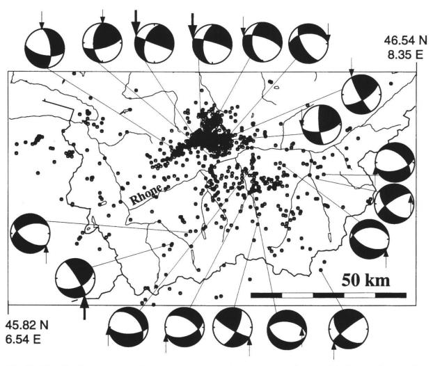
**Fig. 11:** Herdflächenlösungen, die für stärkere Ereignisse im Untersuchungsgebiet konstruiert werden konnten. Die Pfeile bezeichnen die mit Hilfe der Stressinversion bestimmten aktiven Bruchflächen.
