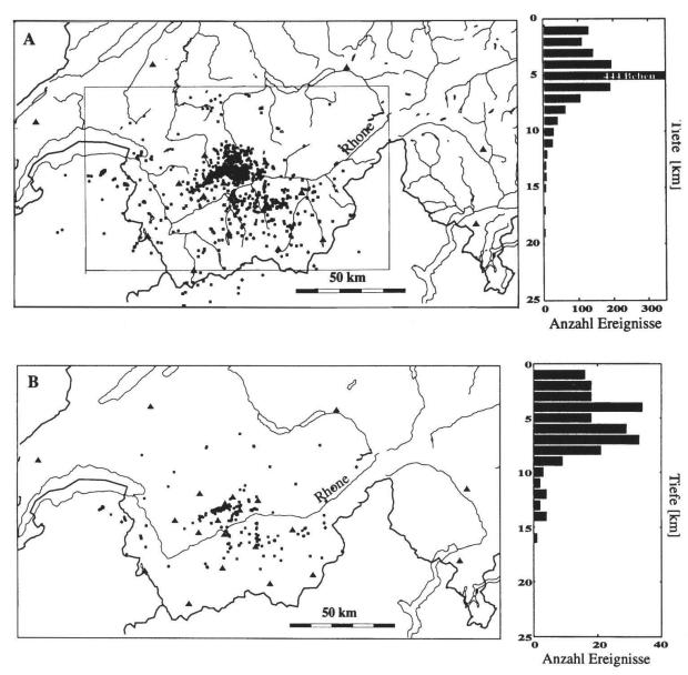
**Fig. 5:** A: Epizenterkarte des Wallis. Das Rechteck in der Karte bezeichnet das Untersuchungsgebiet, aus dem die Daten ursprünglich ausgewählt wurden. Alle 1497 lokalisierbaren Ereignisse sind dargestellt. Auf der rechten Seite ist die Herdtiefenverteilung gezeigt. B: Selektionierter Datensatz für die Simultaninversion. Siehe Text für weitere Erklärungen.
