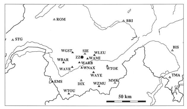
**Fig. 4:** Erdbebenstationsnetz im Wallis. Offene Dreiecke: Permanente Stationen des Schweizerischen Erdbebendienstes. Die Staudammstationen EMS, DIX, MMK sind mit 2 Geräten in einem Abstand von ca. 1 km instrumentiert und jeweils nur mit einem Dreieck markiert. Ausgefüllter Punkt: Stationsnetz Zeuzier. Ausgefüllte Dreiecke: Temporäre Stationen (1989-1991).
