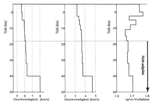
**Fig. 6:** Tiefenverteilung der seismischen P- und S-Wellen Geschwindigkeiten für das Untersuchungsgebiet. Rechts ist die aus den P- und S-Geschwindigkeiten ermittelte vp/vs Verteilung dargestellt. Siehe Text für weitere Erlärungen.
