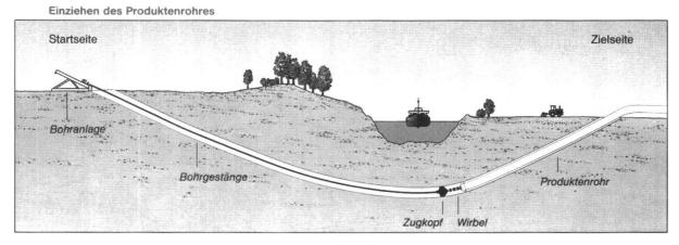
Foto 4: Arbeitsschritte zur Herstellung einer langen, zielgenauen Dükerbohrung
