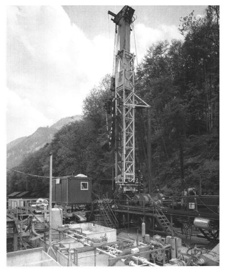
**Foto 2:** Schrägbohranlage für Sondier- und Zielbohrungen RC-7; 70 to Hakenlast
