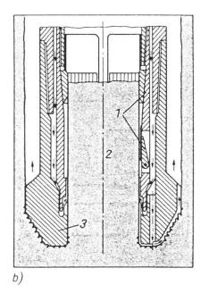
Fig. 4: Schematische Darstellung der Spülungskanäle a) bei einer konventionellen Bohrkrone b) bei einer modifizierten Bohrkrone. Auf beiden Bildern ist die rechte Hälfte um einen kleinen Betrag gegen die linke verdreht, um die Spülungskanäle sichtbar zu machen.
