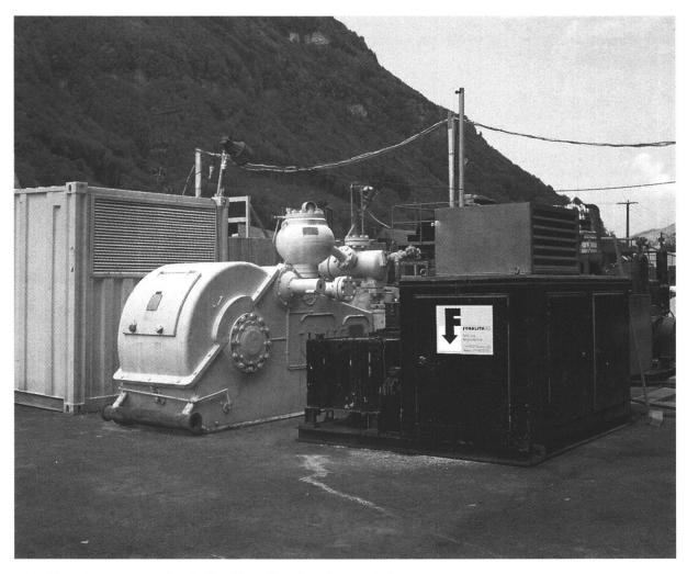
Foto 3: Spülpumpen mit schallgedämpften Antriebscontainern
