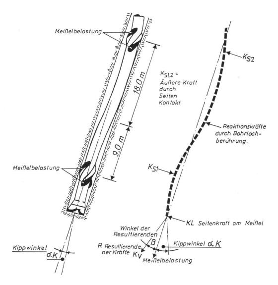
**Fig. 5:** Durch den gezielten Einsatz von Stabilisatoren kann die Biegesteifigkeit des Bohrstranges erhöht werden, so dass dieser durch den Andruck nur noch eine minimale elastische Verformung erfährt. Als Konsequenz wird die Resultierende aller angreifenden Kräfte einen möglichst kleinen Winkel zur Bohrlochachse einnehmen; die Richtungsgenauigkeit wird optimiert.
