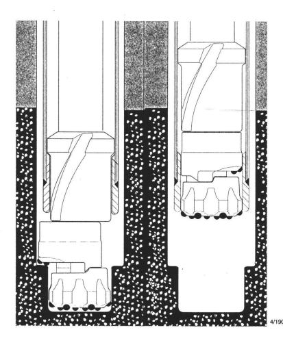
**Fig. 1:** Beim Ziehen der Hammerkrone wird der Räumer über eine Drehung eingeklappt
