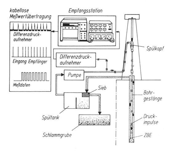
**Fig. 7:** Datenübertragung der selbststeuernden Zielbohrstange ZBE 3'000 über Druckimpulse im Spülungsstrom
