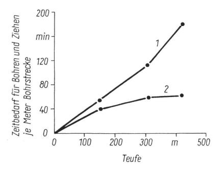
Fig. 3: Vergleich zwischen einem konventionellen Doppelkernrohr (1) und einem Seilkernrohr (2)
