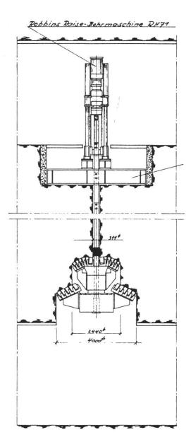
Fig. 8: Vorbohrung für Schachtbauten
