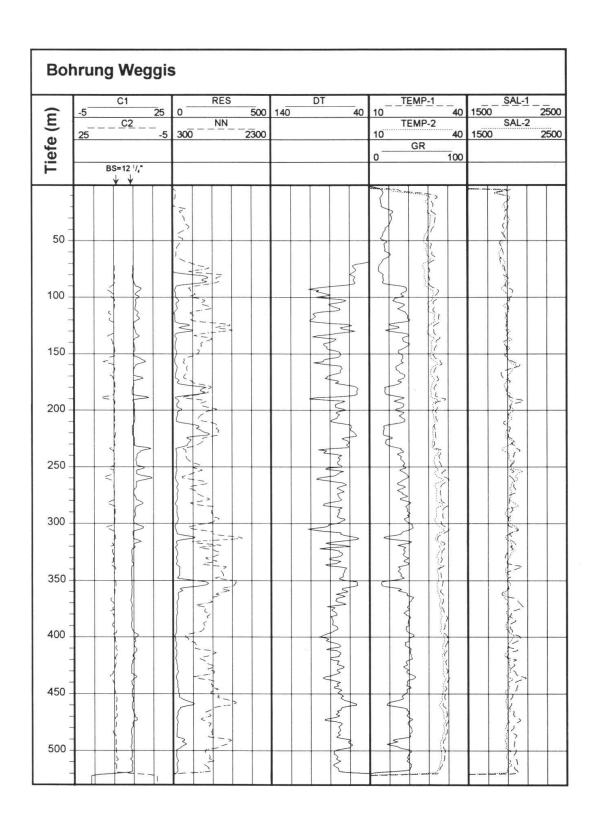
Fig. 7: Logs der 1. Messkampagne am 19. März 1993 (0 bis 550 m). C = Vierarmkaliber [Zoll], BS = Bit size;  $RES = Formationswiderstand [\Omega m];$  NN = Neutron [counts per second cps];  $DT = Sonic [\mu s/ft];$  TEMP = Temperatur [°C]; GR = Gamma Ray [counts per second cps]; $SAL = Elektrische Spülungsleitfähigkeit [\mu S/cm] bei 20 °C.$
