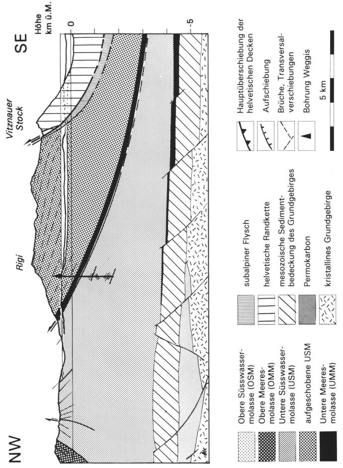
Fig. 4: Geologisches Übersichtsprofil durch die Rigi (verändert nach Buxtorf et al. 1916, autochthoner Bereich nach Vollmayr & Wendt 1987; Profilspur vgl. Fig. 3).
