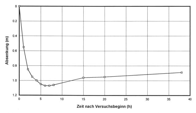
Fig. 10: Pegelmessungen im Bohrloch 4. bis 9. August 1993 (siehe Text)
