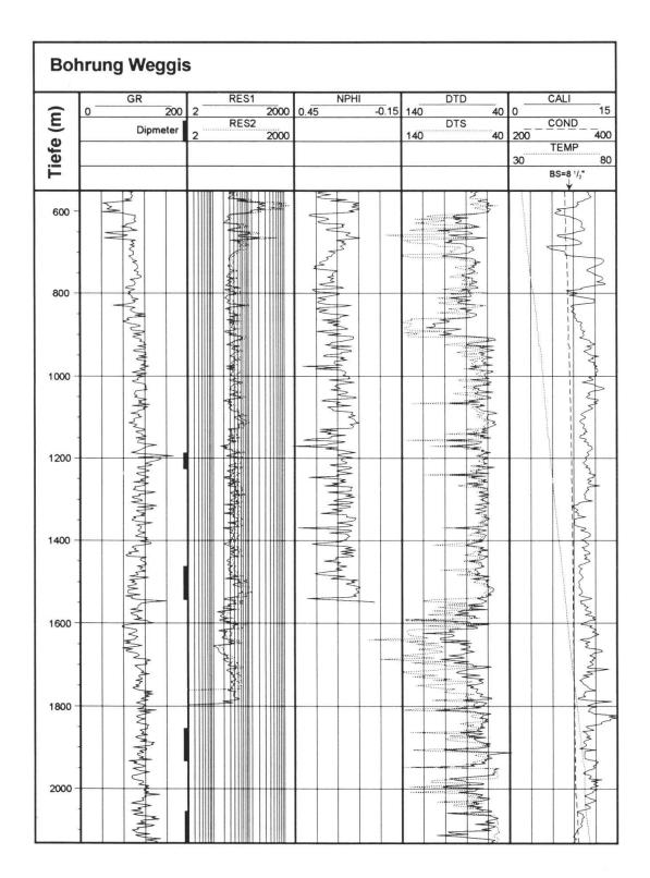
Fig. 8: Logs der 2. Messkampagne am 12./13. Juli 1993 (512 m bis 2'136 m) GR = Gamma Ray [American Petroleum Institute API]; RES = Formationswiderstand [ $\Omega$ m], logarithmische Darstellung; NPHI = Neutron-Porosität [-]; DTD = Sonic deep [ $\mu$ s/ft]; DTS = Sonic shallow [ $\mu$ s/ft]; CALI = Einarmkaliber [Zoll], BS = Bit size; COND = Elektrische Spülungsleitfähigkeit [mS/m] bei 20 °C; TEMP = Temperatur [°C].
