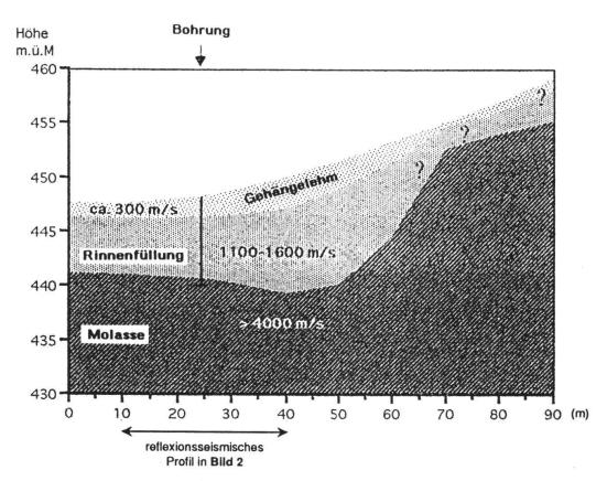
Bild 3 Refraktionsseismische Auswertung auf dem verlängerten Profil in Bild 2. Das refraktionsseismische Laufzeitdiagramm oben zeigt ein verwirrendes Bild unregelmässig verlaufender Laufzeitsegemente und von lokal stark unterschiedlichen Geschwindigkeiten in den Deckschicht(en). Die geologische Interpretation der rechten Profilhälfte (untere Abbildung) ist mit einer Fehlertoleranz von 30 - 35% lediglich eine grobe, subjektiv gefärbte Einschätzung der Lage.
