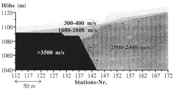
Bild 1 Kombinierte Untersuchung einer geologisch komplexen Situation mit Reflexions- und Refraktionsseismik im Bergsturzgebiet oberhalb Flims GR. Die Untersuchung steht im Rahmen geologischer Abklärungen zum Bau eines Strassenumfahrungstunnels.
