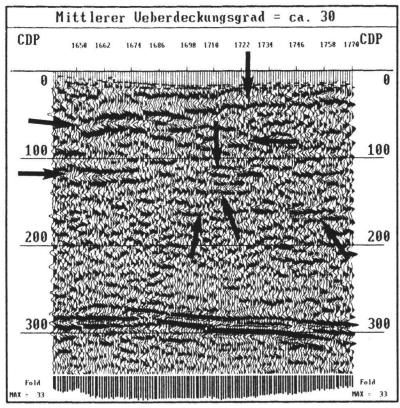
**Bild 4** Reflexionsseismischer Profilabschnitt mit einer Überdeckung von 12 (oben) und 30 (unten). Die Pfeile markieren die prominentesten Stellen, an denen die höhere Datendichte die Reflektoren deutlich besser abbildet. Das obere Profil ist wegen des schlechten Nutz-/Störsignalverhältnisses, verursacht durch die geringe Datendichte, für eine geologische Interpretation zu wenig aussagekräftig.
