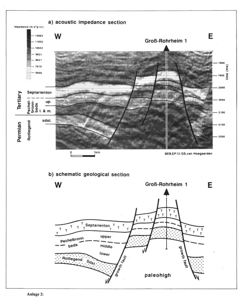
Akustische Impedanzsektion und schematischer geologischer Schnitt über die Struktur Groß-Rohrheim 1, NE Worms.
