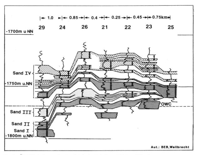
Fig. 6: Ölfeld Eich: Gamma Ray Log-Schnitt der Pechelbonn Schichten (Oligozän).
