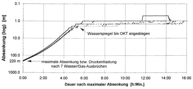
Fig. 6: Wasserspiegel-Anstieg nach 7 überlagerten Wasser/Gasausbrüchen (Tiefendruckmessung vom 28.4. - 6.5.1992).
