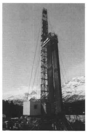
Fig. 1: Bohranlage für die Geothermie-Tiefbohrung Pro San Gian, St. Moritz
