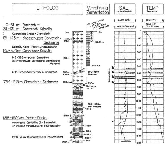
Fig. 5: Bohrprofil mit Verrohrungsschema und Temp/Sal-Log (2. Run vom 27.4.1992)
