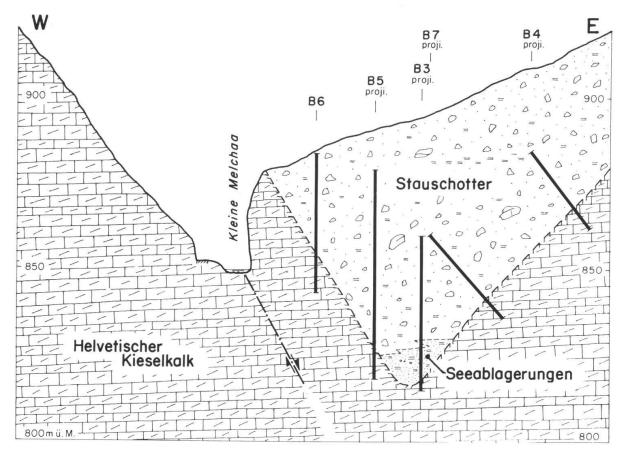
Figur 3: Geologisches Querprofil durch den epigenetischen Tallauf bei der Lochalp im Kleinen Melchtal (B3 ÷ B7 = teilweise in die Profilebene projizierte Kernbohrungen, zur Lage des Profils vgl. Fig. 2).
