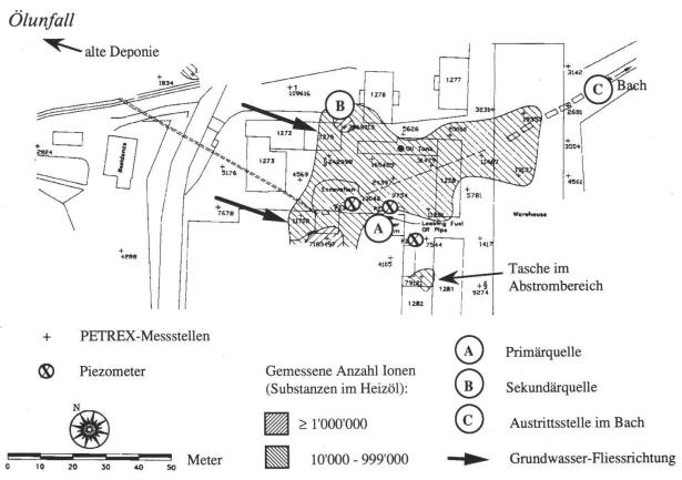
Figur 2: Durch PETREX ermittelte Ölfahne im Untergrund
