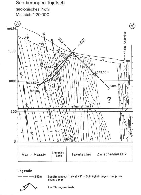
Fig. 3 Sondierbohrungen Clavaniev an der Grenze Aaremassiv - Tavetscher Zwischenmassiv (TZM) (nach Büro Dr. T.R. SSCHNEIDER)
