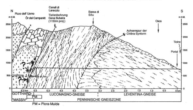
Fig. 4 Geologisches Profil durch die Pioramulde mit Sondierprojekt (nach Dr. T.R. Schneider, geändert)
