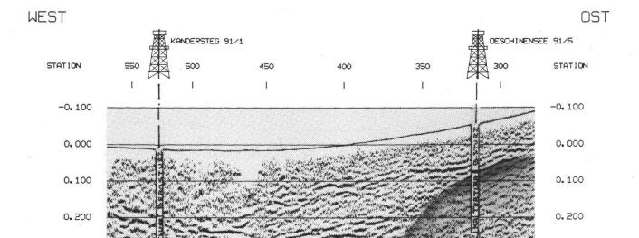
Fig. 6 Seismische Profil bei Kandersteg (Untergrenze Lockergesteine in Bohrungen kalibriert) (nach Geoexpert AG - Schlussbericht Seismische Messungen NEAT 1990)
