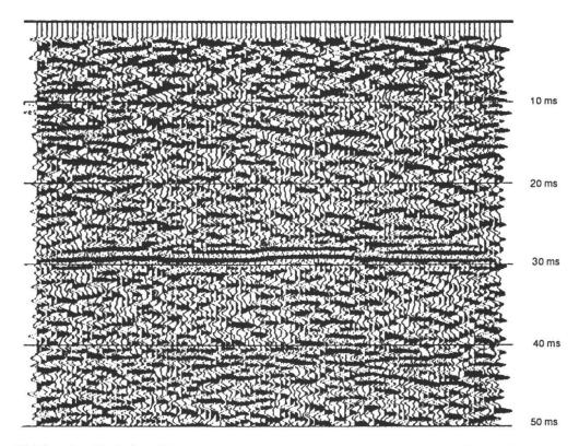
Bild 4 Gleiches Profil wie in Bild 3 mit doppelt so grossen Anregungs- und Empfängerabständen
