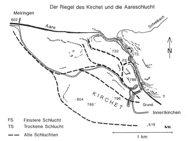
Fig. 2: Der Riegel des Kirchet mit Aareschlucht und den aufgefüllten alten Schluchten (nach MÜLLER 1938).
