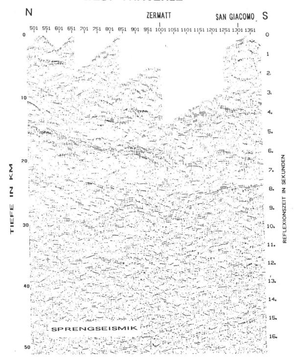
Fig. 15 Teilstück des Sprengschussprofiles der Westtraverse W-3. Der Grenzkamm zwischen dem Zermattertal im Norden und dem Val d'Ayas, einem Seitental des Aostatales, wurde mit einer Reihe von je drei Sprengschüssen unterschossen. Das Profil zeigt unter der sogenannten Basis des Penninikums (auf ca. 6,5 sek.) noch weitere flachliegende deckenartige Einheiten (vergl. Strichzeichnung Bild 10).
