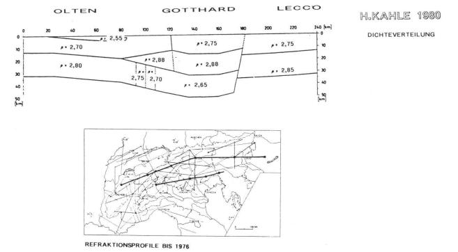
Fig. 4 1956 hielt die Refraktionsseismik Einzug in die Alpen (Westalpen). Erste Ergebnisse aus den Zentralalpen erschienen in den sechziger Jahren (Ansorge, 1968). Die ersten kontinuierlichen Längsprofile wurden in den siebziger Jahren aufgenommen. Damit begann die systematische Erforschung der tieferen Krustenstruktur der Alpen.
