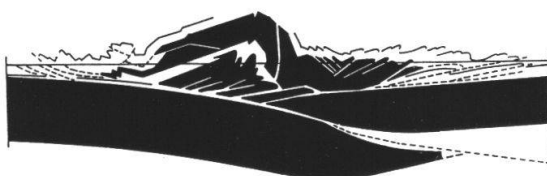
Fig. 5 Geologische Profile durch die Alpen vor NFP 20. Das Axialgefälle beidseitig der Tessinerkulmination ermöglichte eine geometrisch einwandfreie Konstruktion von Profilen in den Walliser- und Bündneralpen bis in eine Tiefe von 10-15 km. Diese Konstruktion, basiert auf axialer Projektion, setzte einen gewissen Zylindrismus der Alpenen Strukturen über Distanzen von 50-100 km voraus.
