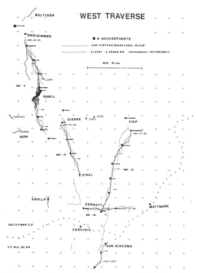
Fig. 11 Lagekarte der reflexionsseismischen Profile der Westtraverse. Es handelt sich um Vibro- und Sprengschussseismik. Von Interesse ist die Position der «Common depth points», d.h. die gemeinsamen Reflexionspunkte oder Tiefenpunkte der Mehrfachüberdeckung.
