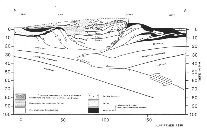
Fig. 7 Geologisches Krustenprofil entlang der Ost- und Südtraverse von A. PFIFFNER. Es handelt sich hier um die erste zusammenfassende geologische Interpretation der NFP 20 Seismik. Neu ist die Deckenstruktur des insubrischen Kristallins am Südrand der Alpen, das kontinuierliche Abtauchen der Europäischen Kruste bis an den Südrand der Alpen und das keilartige Vordringen des Adriatischen Sporns, der sogenannten Afrikanischen Kruste, unter die Alpen.
