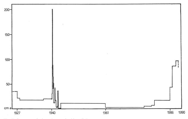
Fig. 5 Spostamenti misurati presso la chiesa di Campo
