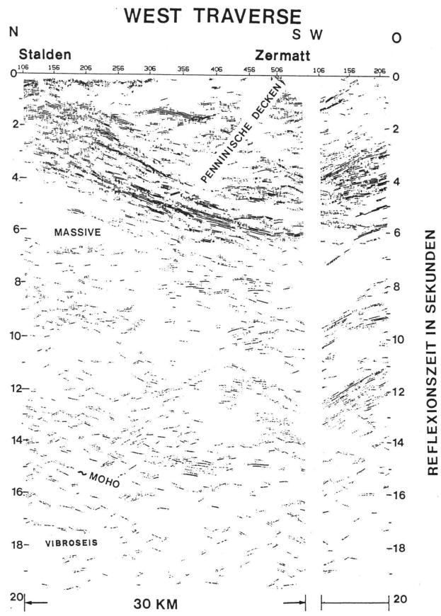
Bild 16a Vibroseisprofil Stalden - Zermatt. Das Querprofil bei Zermatt (Zmuttgletscher - Furri - Findelngletscher) zeigt das alpine Axialgefälle über der Moho. Die Wiedergabe der reflexionsseismischen Krustenprofile im Kleinformat erwies sich als ausserordentlich schwierig. Die wiedergegebenen seismischen Profile (Bilder 5, 16, 17 und 18a wurden mit speziellen Koherenzfiltern bearbeitet und sodann von sporadischen Streupunkten, welche das Bild unnötig stören, gesäubert.
