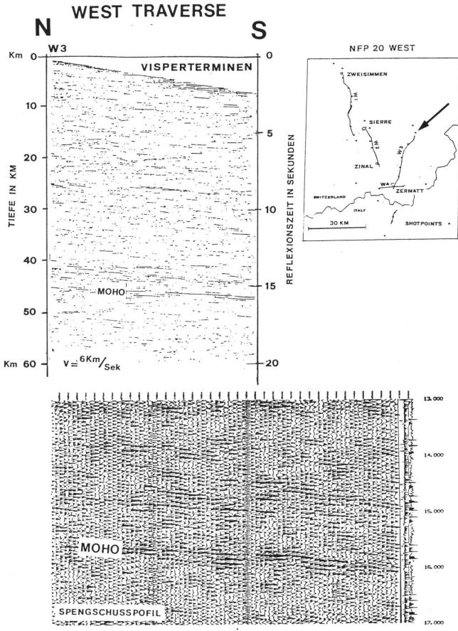
Bild 19 Profil des Sprengschusses Visperterminen (Schusspunkt im Talboden des Vispertals) in die Geophonlinie W-3 Stalden — Zermatt. Das Reflexionsband der Moho zeichnet sich auch in dieser Tiefenlage von ca. 48 km noch deutlich ab.
