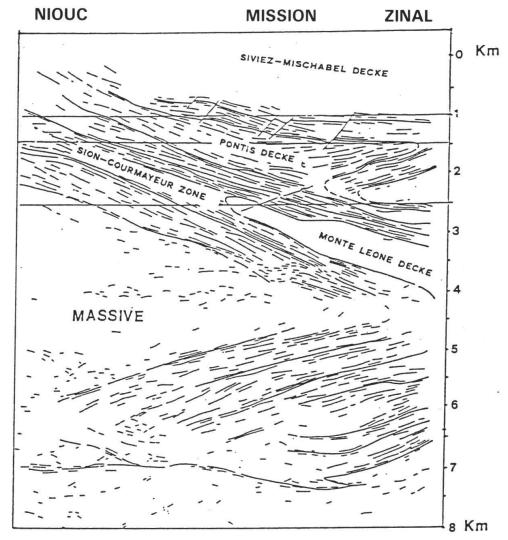
Bild 15a Vorläufige geologische Interpretation des Vibroseisprofiles des Val d'Annivier nach A. ESCHER und A. STECK in L. DU BOIS, J. BESNARD, A. ESCHER, W. FREI, L. LEVATO, R. MARCHAND, R. OLIVIER, M. OUWEHAND, S. SELLAMI, A. STECK und J.J. WAGNER (1989) (in press).
