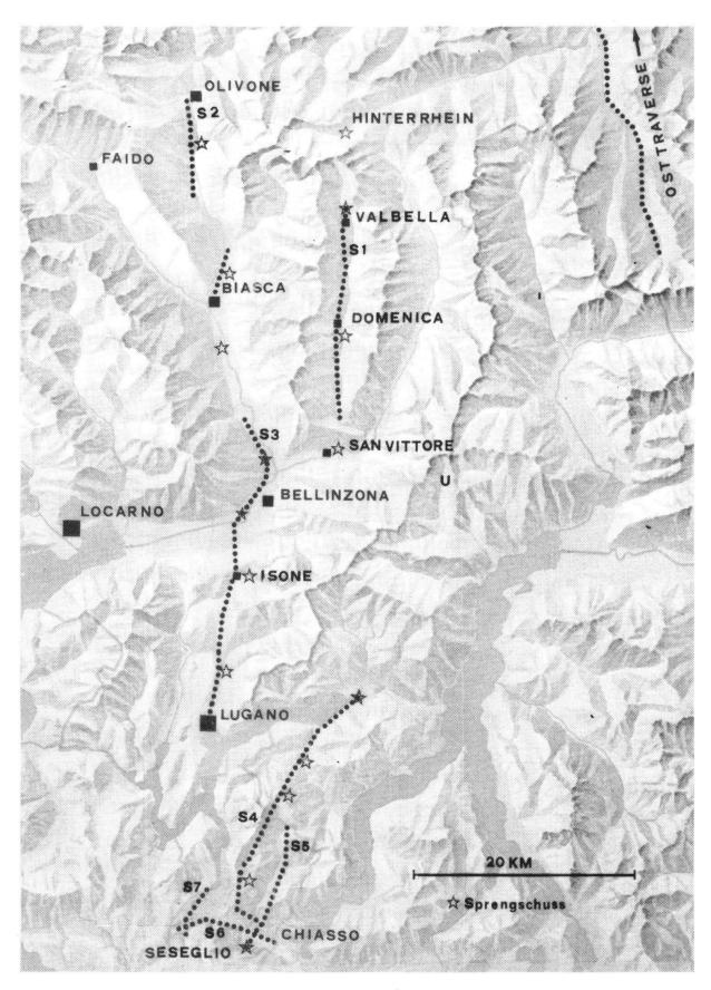
Bild 3 Reliefkarte der Südschweiz mit dem Trasse der Südtraverse von NFP-20 und den Schusspunkten der Spregschussseismik.
