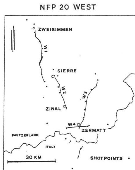
Bild 14 Strichzeichnung der kombinierten Sprengschussprofile der Westtraverse von Zweisimmen nach Zinal. Die abtauchende Penninische Deckenbasis lässt sich vom Rhonetal (Station 556) bis nach Zinal verfolgen. (Vergleiche Osttraverse Bild 22 und 23). Das nach Norden abtauchende Reflexionspaket zwischen 10 und 30 Sekunden deutet auf eine grossräumige Verteilung der Kontinentalen Kruste.
