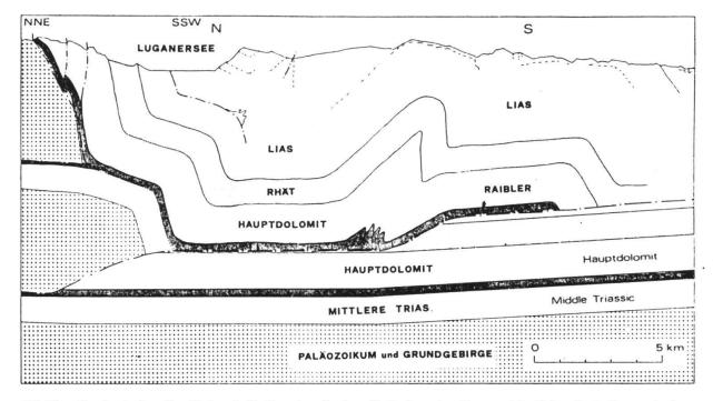
Bild 9a Geologisches Profil durch die Lombardischen Kalkalpen im Grenzgebiet Schweiz-Italien zwischen Lago di Como und Lago di Lugano nach H. LAUBSCHER (1985). Der Triassische Hauptdolomit und der darüberliegende Rhätische Conchodondolomit entsprechen den wichtigsten Reservoir Horizonten in den Oel- und Gasfeldern der Gegend Milano-Bergamo.
