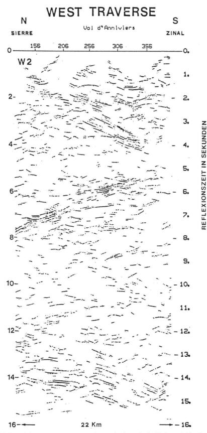
Bild 17b Sprengschussprofil des Val d'Annivier. Das aus der Gegend von Zinal aus 6 sek. Tiefe nach Norden auf 10 sek. abtauchende Reflexionsbündel deutet auf eine grossräumige Verkeilung der Europäischen und Adriatischen Kruste. Letztere stösst keilartig unter die nördliche Oberkruste vor und zwingt diese (Penninikum und Massive) nach oben auszuweichen, mit nach Süden zunehmenden Hebungsbeträgen.
