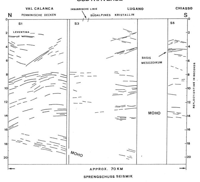
Bild 7 Vorläufige Strichzeichnung der Sprengschussprofile der Südtraverse. Die Unterkruste des Südkontinentes dringt nach Norden bis unter das Penninikum vor. Die ober Kruste erscheint abgestreift und nach Süden zurückgeworfen.
