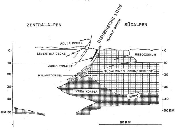
Bild 8 Prognostisches Profil durch die Insubrische Linie im Bereich der Südtraverse nach P. HEITZMANN (1987).
