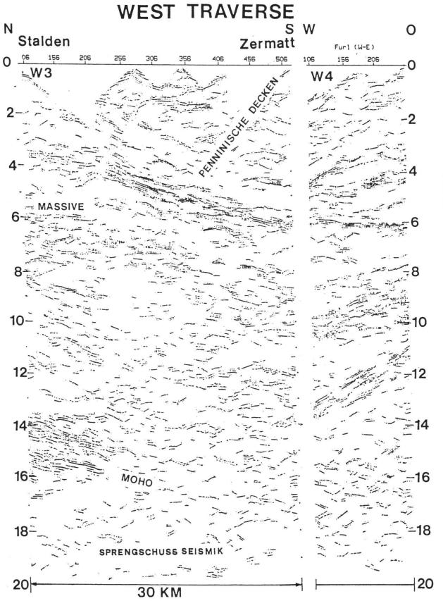
Bild 16b Die Sprengschussprofile W-3 und W-4 zeigen ein Mohoband das von 14-16 sek. am Nordrand auf 16-18 sek. in der Gegend von Zermatt abtaucht. Mit etwas Courage lässt sich die Moho flach unter die gemäss den alpinen Axialgefälle nach Westen abtauchenden Schichten durchziehen, die somit über dem Mohoband abgeschert scheinen.
