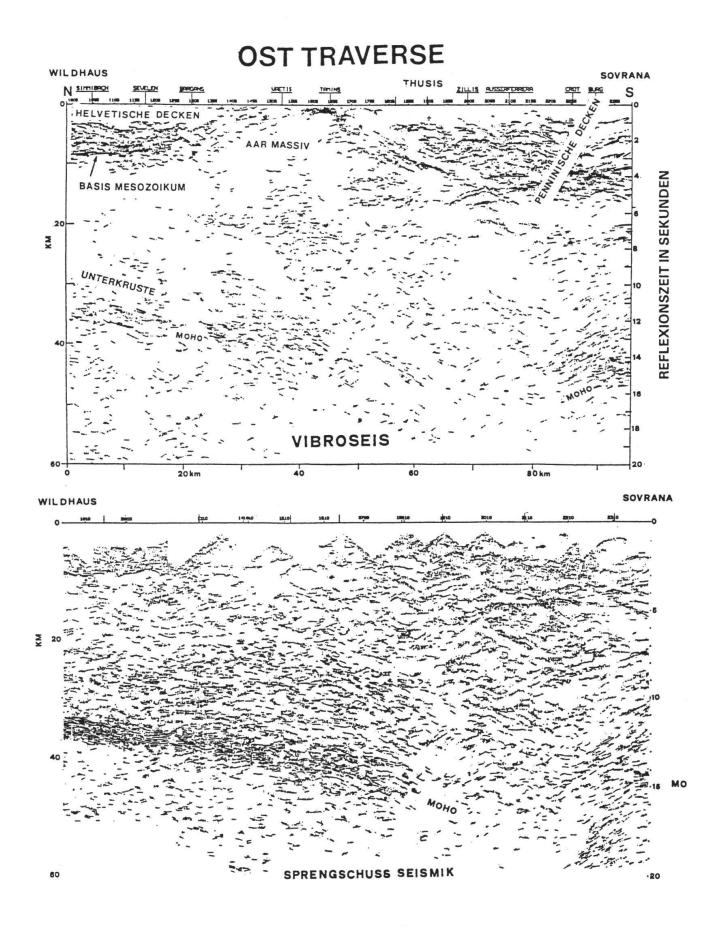
Bild 18a Vergleich von Vibroseis und Sprengschussseismik der Osttraverse von Wildhaus am Säntis nach Sovrana an der Grenze Schweiz-Italien.
