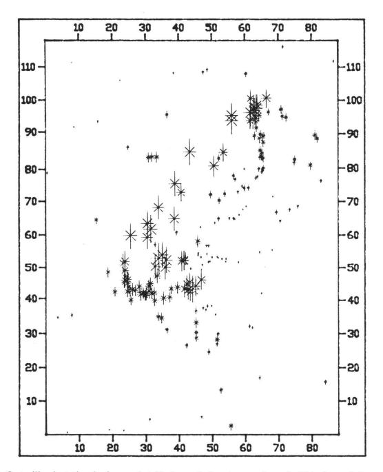
Fig. 1. Carte d'implantation des forages, la taille des symboles est proportionnelle à l'épaisseur de la couche réservoir (les coordonnées sont exprimées en kilomètres).
