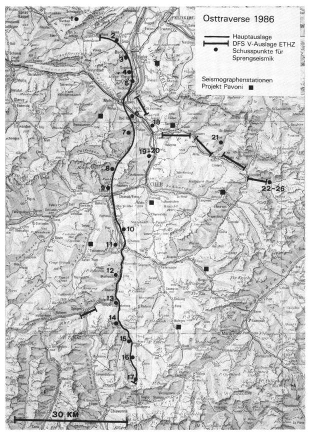
**Bild 18** Trasse der Osttraverse von Wildhaus am Säntis über Ragaz, Tamins, Thusis und Andeer zur Alpe Sovrana im Val Madris, an der Grenze Schweiz/Italien. Die Seismographenstationen des Projekts Pavoni sind für eine mehrjährige Beobachtung der in diesem Gebiet besonders häufigen Erdbeben stationiert.
