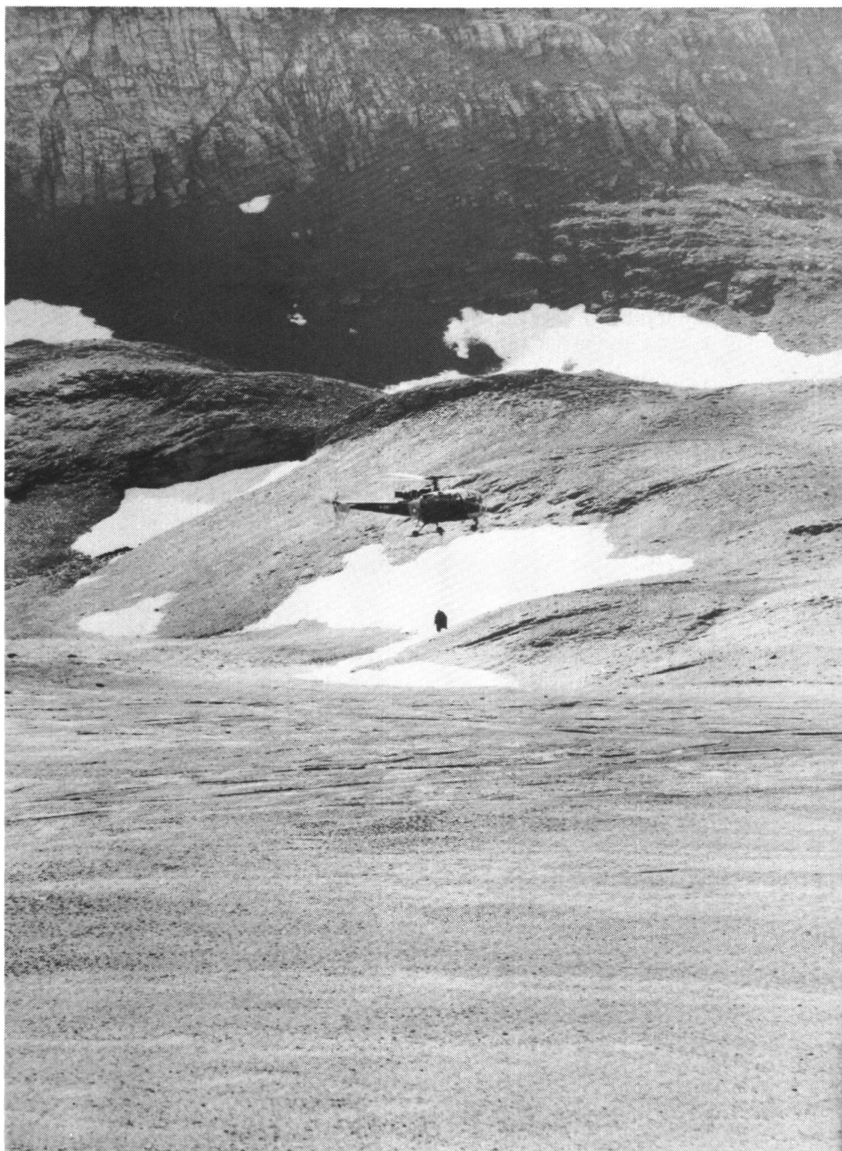
Bild 7 Heli - Fallgewichtseismik. Experimente mit neuen Energiequellen für Reflexionsseismik unter alpinen Bedingungen gehören zur Aufgabe von NFP-20. Hier wird das akustische Signal des Aufpralls eines Fallgewichtes (400 kg Stahlkette), gezielt vom Helikopter, aus Höhen von 50 - 150 Metern abgeworfen, untersucht. Die beweglichen Glieder der zusammengeschweissten Kette erlauben einen einmaligen Aufschlag und verhindern ein elastisches Auf- und Niederschlagen des Fallgewichtes.
