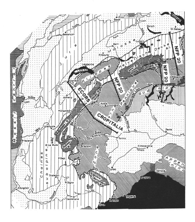
Bild 2 Tektonische Kartenskizze mit den drei Alpentraversen von NFP-20. Die Ost- und Westtraversen reichen vom südlichen Molassebecken bis ins Penninikum, an der Grenze Schweiz/Italien. Die Südtraverse erstreckt sich vom Gotthardmassiv an den Rand des Pobeckens in der Nähe von Chiasso. Die Westalpentraverse von ECORS (Étude continental et océanique par réflexion et réfraction sismique) und CROP ITALIA (Crosta profonda d'Italia) wurde im Herbst 1986 und 1987 aufgenommen.
