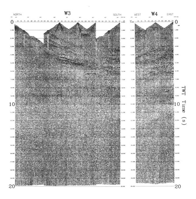
**Bild 16** Sprengschussprofil W3, Stalden-Zermatt, und W4, Zmuttgletscher-Findelengletscher. W4 liegt rechtwinklig am Südende von W3, parallel zum alpinen Streichen.
