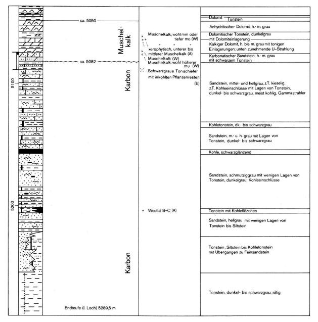
Fig. 5: Entlebuch 1 - Lithologie und Stratigraphie des Karbons, Signaturen nach Shell-Legende
