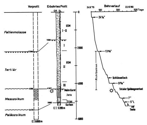
Fig. 2: Entlebuch 1 - Vorprofil, erbohrtes Profil und technischer Ablauf
