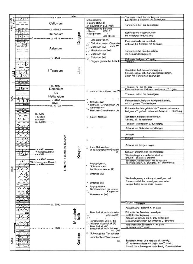
Fig. 4: Entlebuch 1 - Lithologie und Stratigraphie des Doggers, des Lias und der Trias. Signaturen nach Shell-Legende
