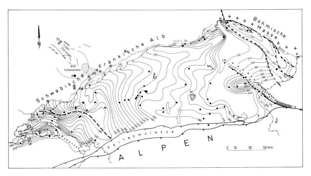
Abb. 5 Linien gleicher Spiegelhöhen des gespannten Malm-Karstwassers (m üb. NN).
