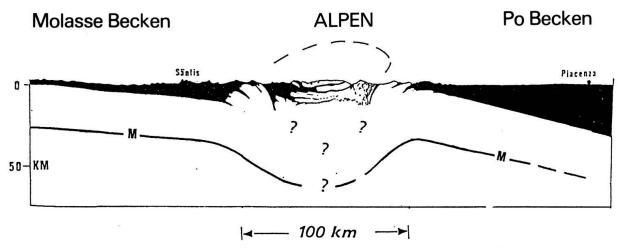
Fig. 2: Die Kruste unterhalb der Alpen ist im Vergleich zur ausseralpinen Kruste auf mehr als die zweifache Mächtigkeit zusammengestaucht. Der Verlauf der Moho (M) ist dank der Refraktionsseismik annähernd bekannt. Das alpine Axialgefälle von ca. 30° im Bereich der Osttraverse macht es möglich, Oberflächenstrukturen bis in eine Tiefe von etwa 10 km mit einiger Sicherheit zu projizieren.
