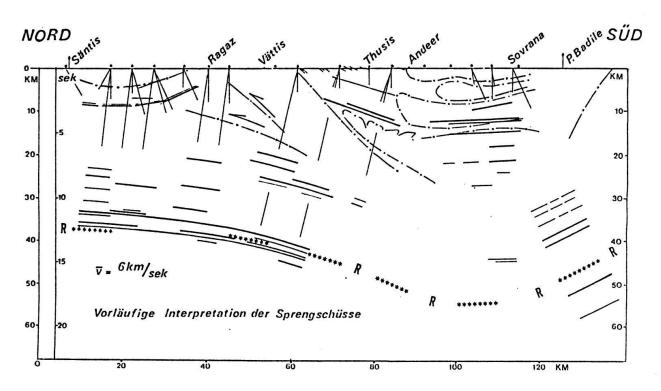
Fig. 5: Vorläufige Interpretation der Sprengschuss-Seismik entlang der Osttraverse. Geneigte Reflektoren sind in die korrekte Position migriert. Die Tiefenangaben sind jedoch ungenau, da keine Terrainkorrekturen angebracht sind, auch ist dem starken Axialgefälle (ca. 30°) gegen NO nicht Rechnung getragen.
