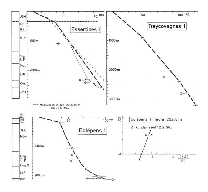
Fig. 6 Temperaturprofile der Bohrungen Essertines 1, Treycovagnes 1 und Eclépens 1; Temperaturaufbaukurve von Eclépens 1 in Teufe 202.8 m; Zeichenerklärung siehe Fig. 2.
