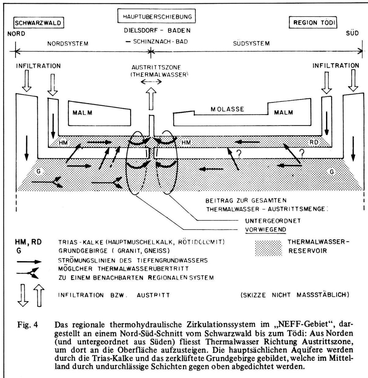
Fig. 4 Das regionale thermohydraulische Zirkulationssystem im „NEFF-Gebiet“, dargestellt an einem Nord-Süd-Schnitt vom Schwarzwald bis zum Tödi: Aus Norden (und untergeordnet aus Süden) fliesst Thermalwasser Richtung Austrittszone, um dort an die Oberfläche aufzusteigen. Die hauptsächlichen Aquifere werden durch die Trias-Kalke und das zerklüftete Grundgebirge gebildet, welche im Mittelrand durch undurchlässige Schichten gegen oben abgedichtet werden.
