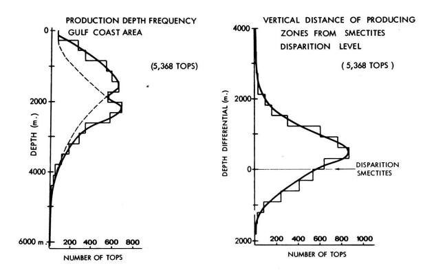
Fig. 3 a) Fréquence des sommets des réservoirs producteurs classés en fonction de la profondeur dans le Gulf Coast. Nombre de réservoirs recensés: 5368, statistique de 1958 (BURST, 1969).
