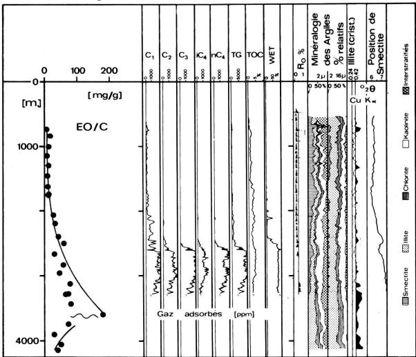
Fig. 6 Comparaison des extraits organiques: EO/C, des gaz adsorbés, de la réflectance de la vitrinite, de la composition minéralogique des fractions inférieures à 2 um et comprise entre 2 et 16 um, de la cristallinité des micas et la migration du pic des smectites et interstratifiés. C<sub>1</sub> méthane; C<sub>2</sub> éthane; C<sub>3</sub> propane; i-C<sub>4</sub> iso-butane; n-C<sub>4</sub> normal-butane; TG somme des gaz; wet, C<sub>2</sub>+C<sub>3</sub>+i-C<sub>4</sub>+n-C<sub>4</sub>/TG.
