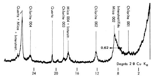
Fig. 1 Diagramme de diffraction X des «Argiles bleues» de Léningrad (Cambrien inf.). Echantillon séché. La cristallinité du matériel 2:1 et de  $0.62^{\circ}2\theta$  CuK. Ces argiles pourraient encore être classées dans la FHP.
