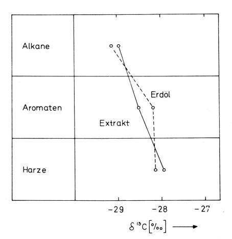
Abb. 5: Isotopenvergleich: Erdöl (Mittelwert von E I) - Extrakt aus potentiellem Muttergestein (Sannois-Fischschiefer)
