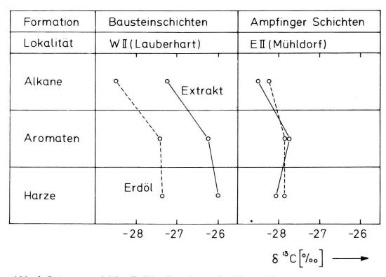
Abb. 6: Isotopenvergleiche: Erdöl - Extrakt aus Speichergesteinen
