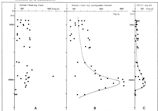
Fig. 3 Fenêtre à huile d'un kérogène type I
