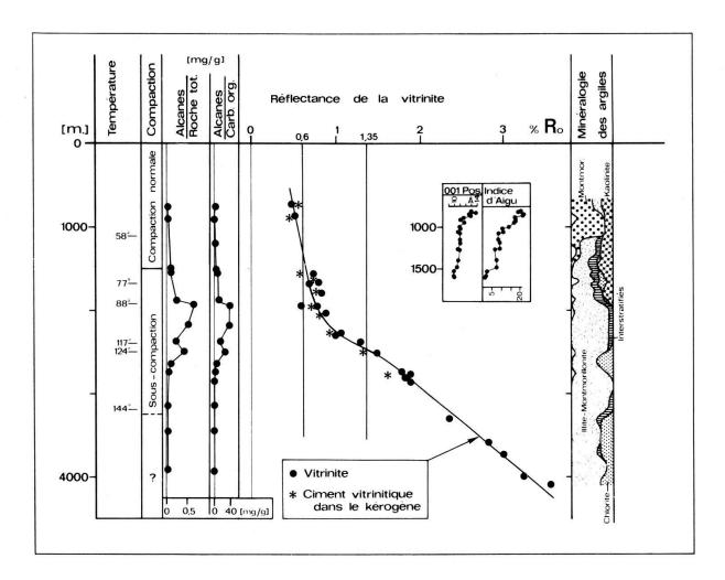
Fig. 7 FHP, kérogène type III,  $R_O$ , température, sous-compaction, disparition des smectites, de la kaolinite, cristallinité et migration des pics de diffraction
