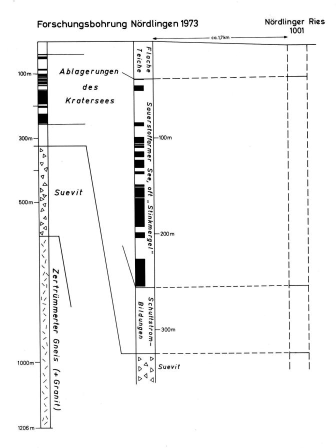
Abb. 2 Die Forschungsbohrung Nördlingen 1973. Links: Gesamtprofil, Mitte: vergrössertes Detailprofil der Seeablagerungen (schwarz = Stinkmergellagen); rechts: nach den Ergebnissen der Forschungsbohrung zu erwartende Schichtfolge in der Untersuchungsbohrung "Nördlinger Ries 1001".
