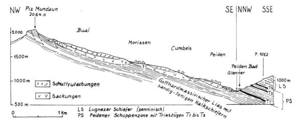
Fig. 2. Schematisches Profil 1:50 000 durch die Schiefersackung des mittleren Lugnez.
